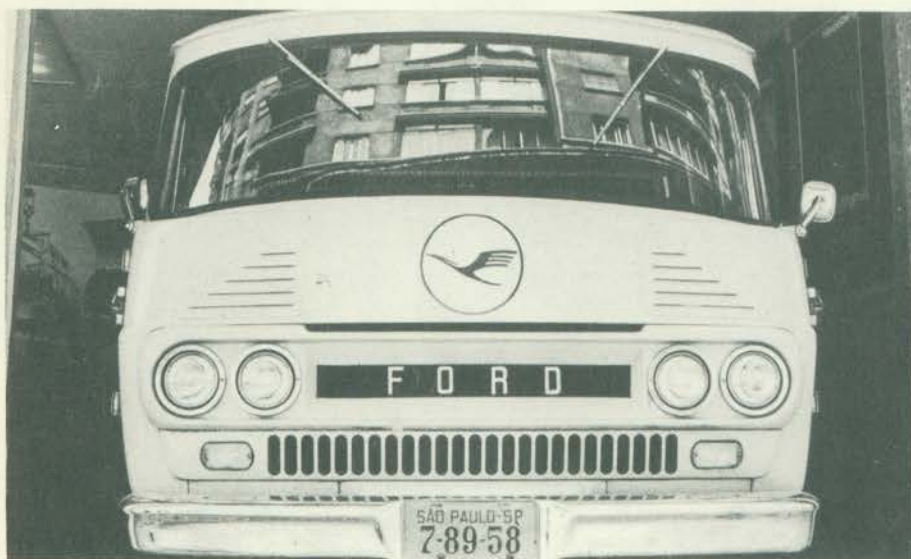
Da carroçaria original só restou a grade dianteira com os quatro faróis.
