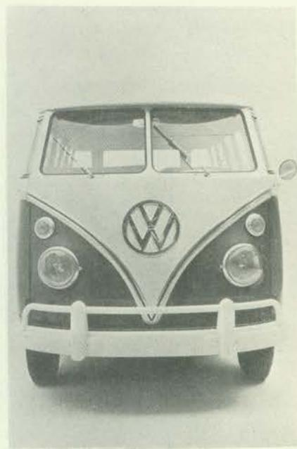
**KOMBI 67** — Com 1.500 cm<sup>3</sup> e 52 CV (SAE) a nova perua Volkswagen transporta uma tonelada. Outras inovações: limpador de pára-brisas de duas velocidades, banco individual ajustável para o motorista, suspensão dianteira com estabilizador, área de frenagem 30% maior, dispositivo no acelerador para maior sensibilidade ao comando.
