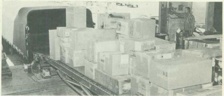
**CORREIA EMBARCA** — Transportador de correia, em linha com um trecho de rolos livres, permite o rápido carregamento de caminhões, em depósitos. De largura equivalente à do veículo que recebe a carga, este transportador permite que os volumes a embarcar sejam arrumados sobre a correia, dispensando assim as manipulações da carga sobre a carroçaria. Indique **Serviço de Consulta n.º 1**.
