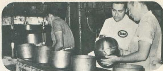
A Bendix do Brasil-Equipamentos para Autoveículos Ltda., em sua linha de produção para a indústria automobilística, inclui, entre outras peças, o cilindro de vácuo do hydrovac. As condições de produção desta peça são bastante severas pois, utilizando-se uma chapa SAE 1010 n.º 16 de espessura .0598 pol., fabrica-se o cilindro de vácuo com 9,5 pol. de diâmetro interno sendo o repuxo de 6,44 pol. Na operação, registrava-se uma perda de, aproximadamente, 30% das peças.
