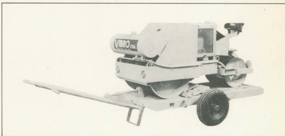
O rôlo vibratório pode ser deslocado rapidamente de uma obra a outra.
