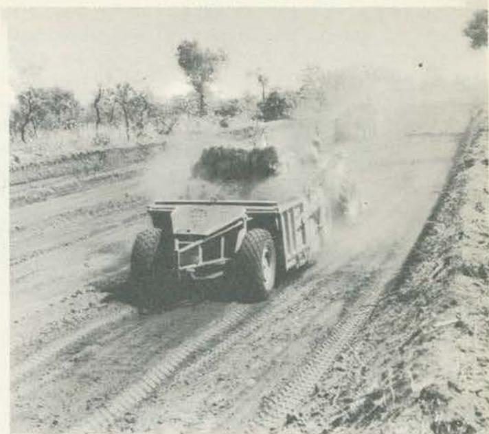
Scraper autocarregador de 6 m<sup>3</sup>, fabricado no Estado do Rio.
