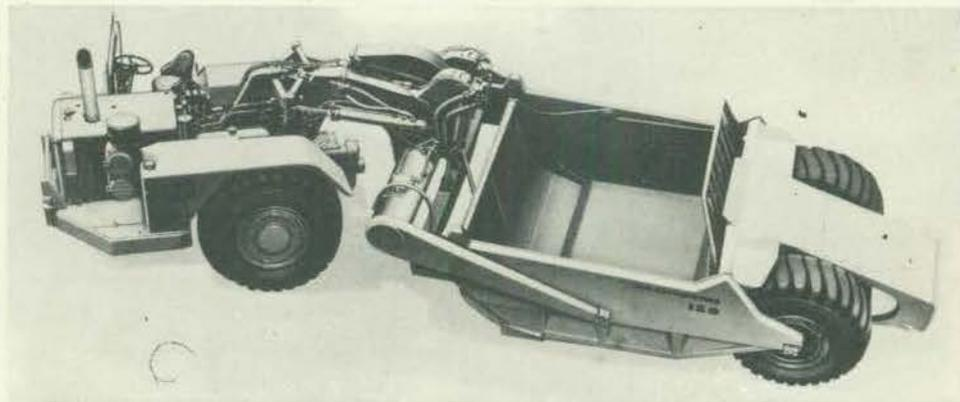
**SCRAPER** — Primeiro scraper nacional totalmente hidráulico. Tem largura de corte de 3 m, capacidade de carga de 21.800 quilos, capacidade coroada de 15,3 m<sup>3</sup> (20j<sup>3</sup>) e de carga rasa de 10,7 m<sup>3</sup> (14j<sup>3</sup>). A caçamba é acionada por dois cilindros de dupla ação. Indique Serviço de Consulta n.º 4.
