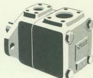
■ Bombas de Palhêtas. Balanceadas hidráulicamente. Suportam pressão de até 175 atmosferas e rotação até 2500 rpm. Permite substituição do conjunto rotativo na própria máquina, sem necessidade de desligar os encanamentos.
