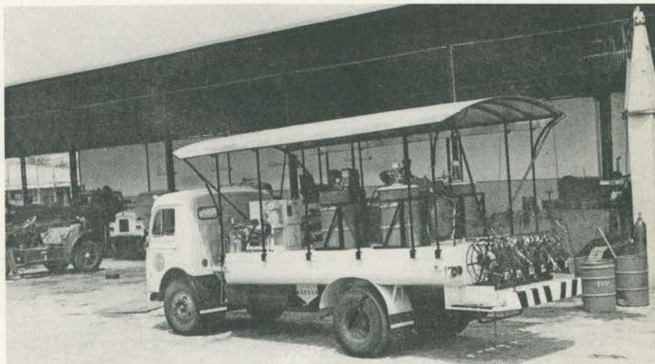
Um comboio convencional de lubrificação compõe-se de um conjunto de tambores, compressor, propulsores e mangueiras, instalados sobre uma unidade móvel. O compressor de ar, movido por motor elétrico ou a gasolina, impele os materiais, através de mangueiras, até o equipamento a ser lubrificado. Se a operação manual dura até uma hora, com o auxílio de um comboio reduz-se a dez minutos. Além dos lubrificantes, o conjunto pode fornecer ar para os pneumáticos, e combustível.
