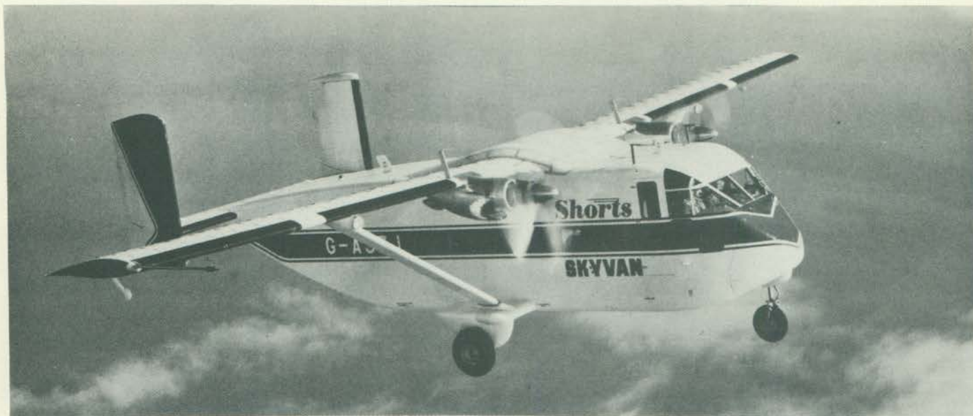
O avião "SKYVAN" foi projetado e construído pela "Short Brothers & Harland Ltd." da Inglaterra, para operar em regiões subdesenvolvidas, com cargas e passageiros. É uma aeronave de porte médio com características para operar em pistas pequenas. Sua construção — asa alta e trem de pouso fixo — facilita a manutenção e aumenta bastante a sua robustez.
