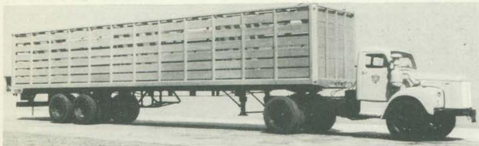
Scania-Vabis modelo L-7638 equipado com semi-reboque para o transporte de gado.
