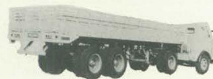
• SEMI-REBOQUE PARA CARGA SÉCA
