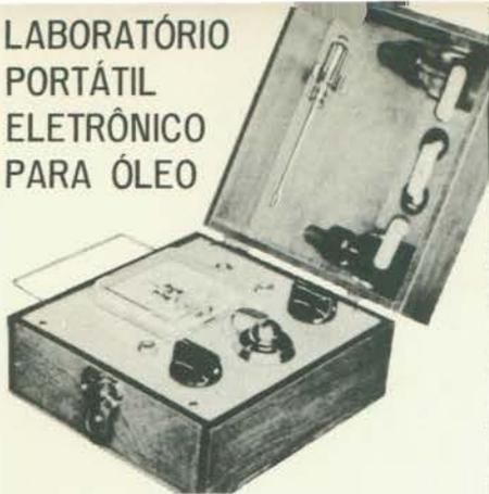
Agora é fácil saber exatamente quando precisa ser trocado o óleo do motor. O Laboratório Portátil Eletrônico é especialista em análise de óleos. Motores à gasolina ou Diesel, não importa. Apenas 3 a 4 gotas, tiradas do medidor de nível, e o aparelho lhe indica se o óleo ainda pode ser utilizado ou se já deve ser renovado. É muito simples. Pense no que significa em economia.
