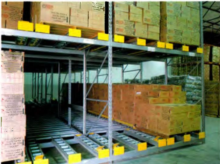
**ARMAZENAGEM DINÂMICA PALLETIZADA** - Princípio F.I.F.O. de fluxo automático
