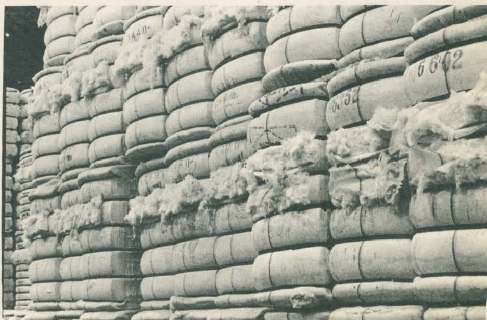
O enfardamento é muito importante, pois os fretes são calculados pela cubagem.
