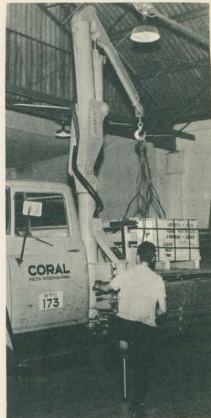
Um dos guinchos utilizados pela Coral para manuseio de volumes até 4 t.
