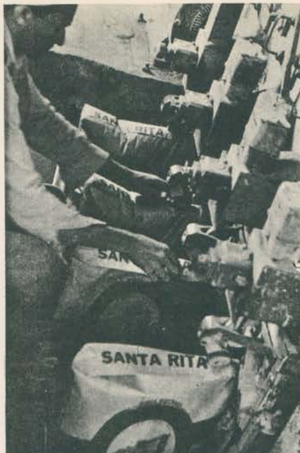
Ensacadeira para cimento com capacidade para 20 sacos de 50 kg/minuto.
