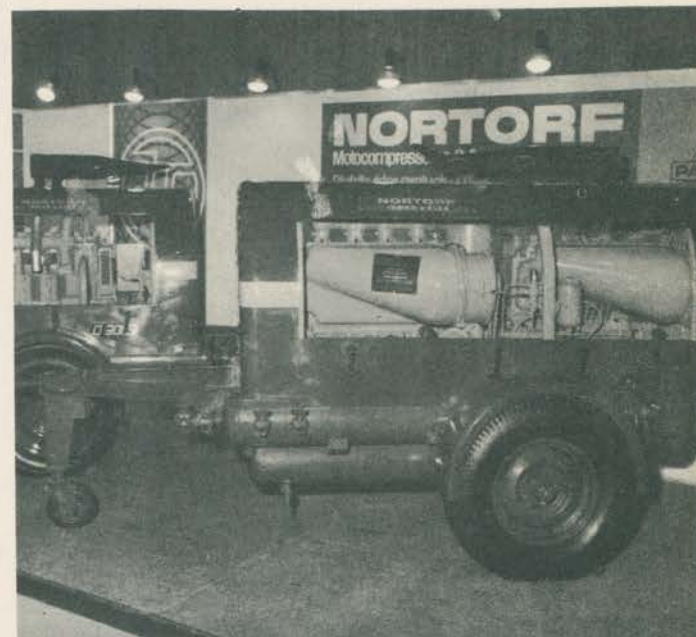
Grupo compressor portátil, acionado por um motor diesel.
