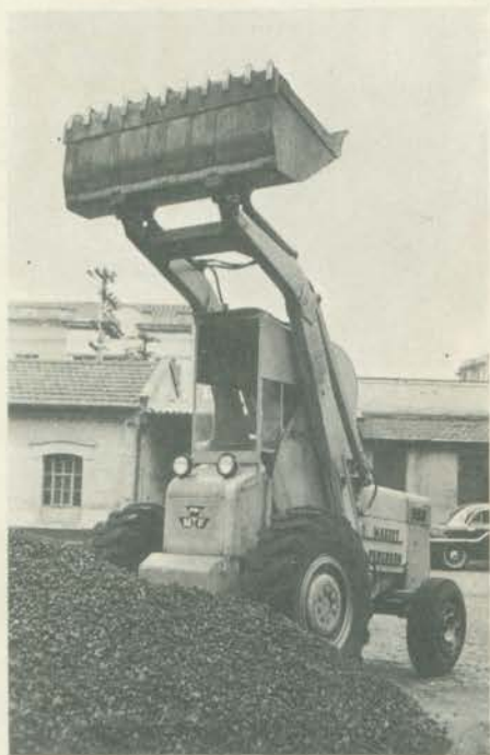
A caçamba cheia de material atinge a altura máxima em apenas 5 segundos.
