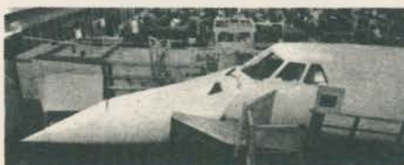
Posições do nariz da aeronave, para voo supersônico, subsônico e pouso.
