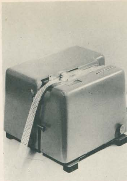
O transmissor envia mensagem à velocidade de 400 caracteres por minuto.
