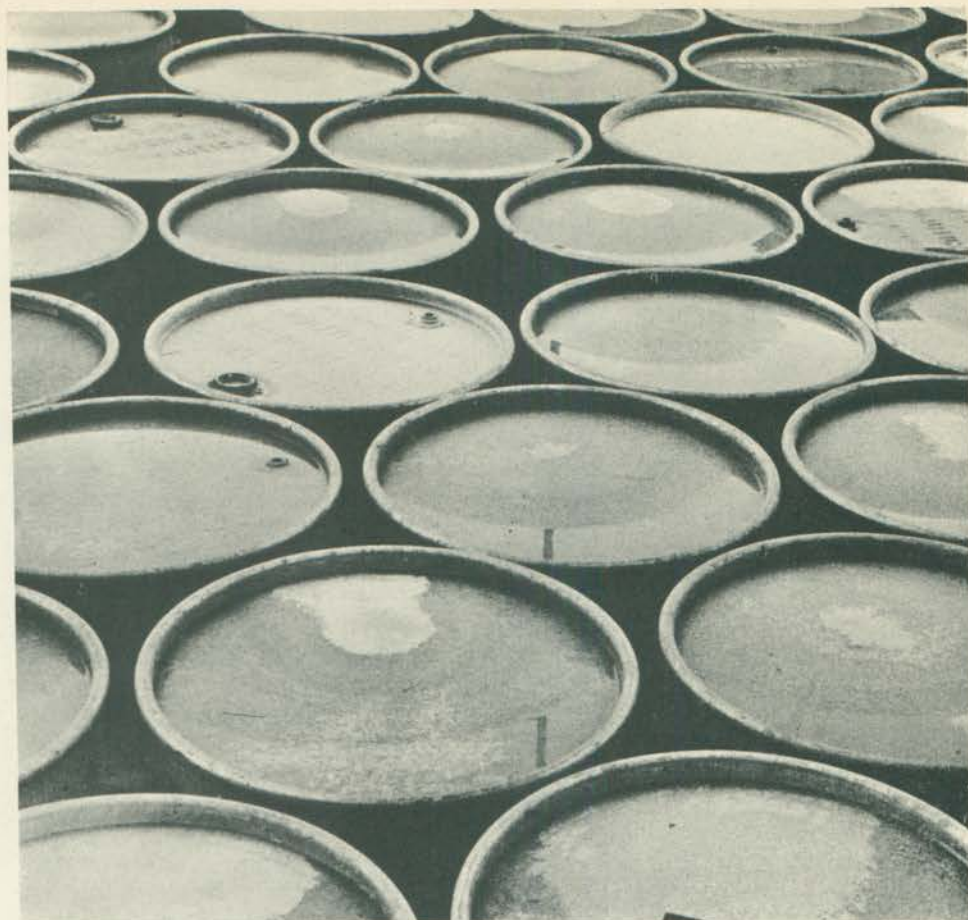
Tambores com revestimento interno transportam materiais ácidos e corrosivos.
