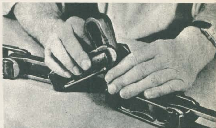
A corrente tipo "Rivetless" é importada da LINK-BELT CO. para melhor qualidade. É facilmente montada e desmontada.
