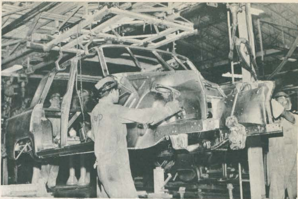
Talhas em monovias movimentam automóveis ao longo da linha de montagem.
