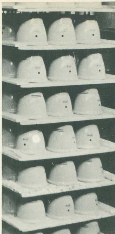
Peças de tamanho médio são estocadas e transportadas sobre pranchas.
