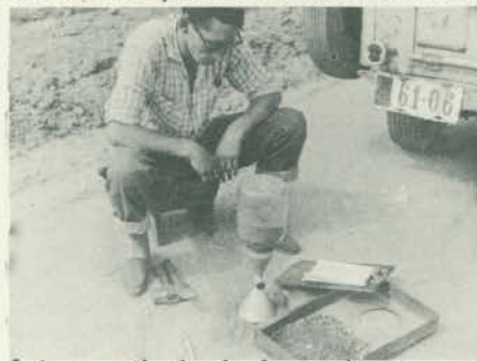
A terra retirada do furo vai para posterior pesagem, medindo-se o volume.
