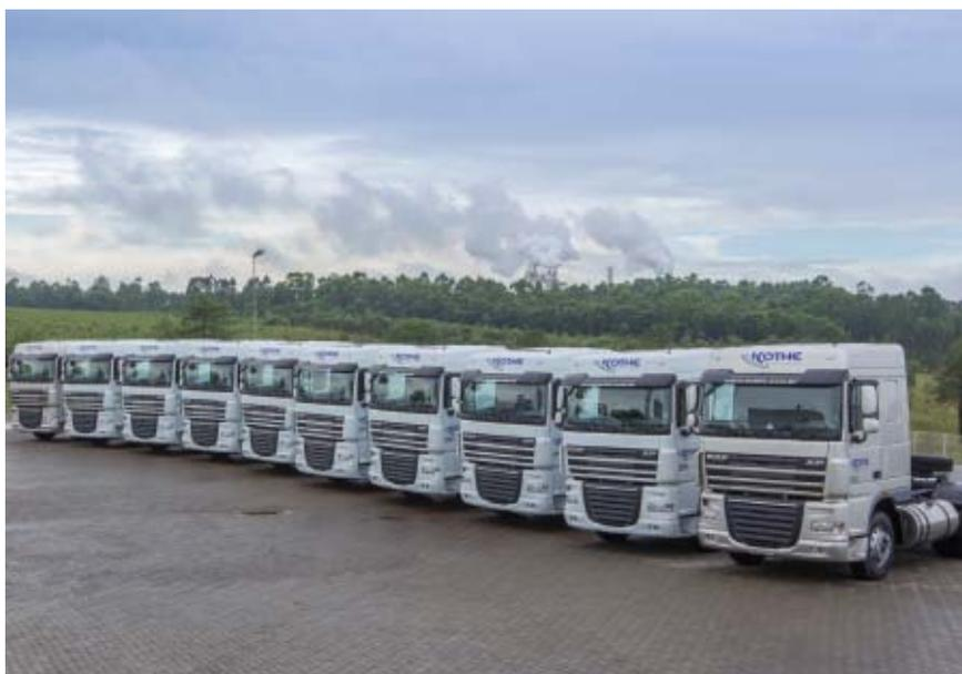
**Os extrapesados DAF XF 105 possuem cabine Space e motor de 460 cv de potência**
