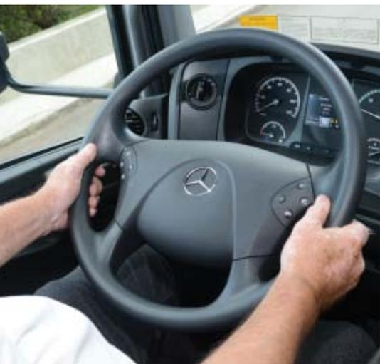
**Com dois conjuntos de botões, o volante multifuncional tem teclas de acionamento para os comandos do painel de instrumentos**
