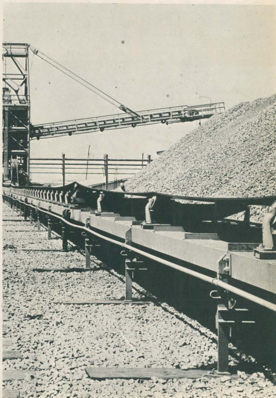
O não-alinhamento da correia de um transportador afeta sua durabilidade.
