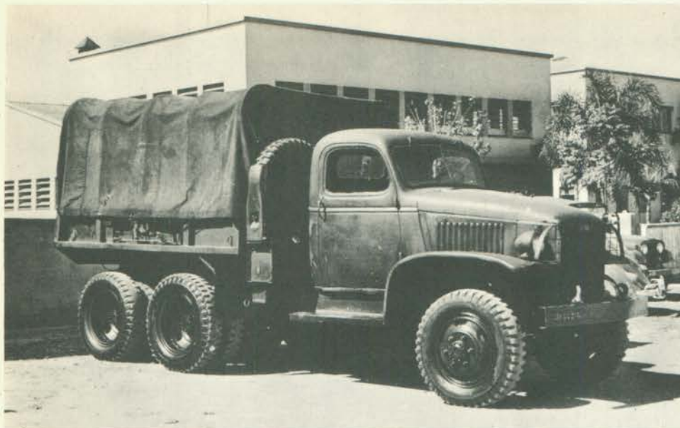
A lei permite o carregamento de até dez toneladas por eixo com quatro pneumáticos.
