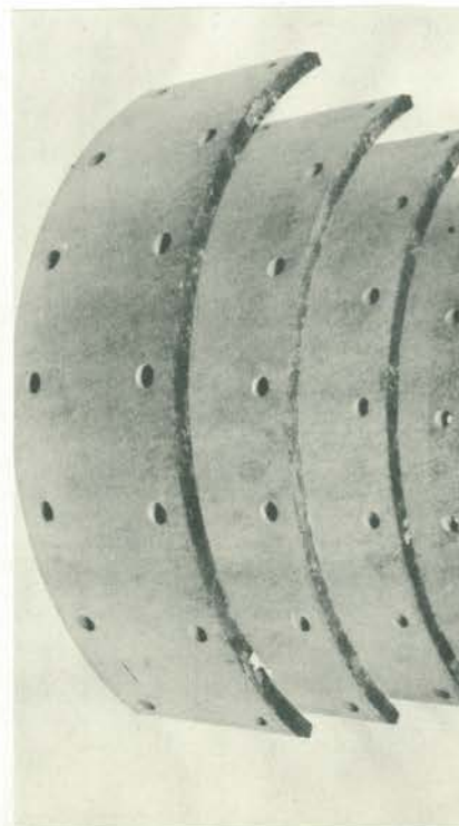
A qualidade das lonas influencia na eficiência dos sistemas de freio.
