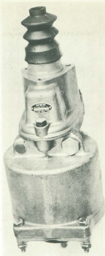
A MWM fabrica o aparelho servo-hidráulico de diversos veículos.
