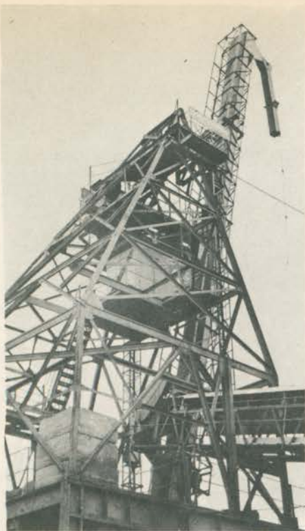
Descarregador com lança tôda elevada para evitar colisões na orla do cais.
