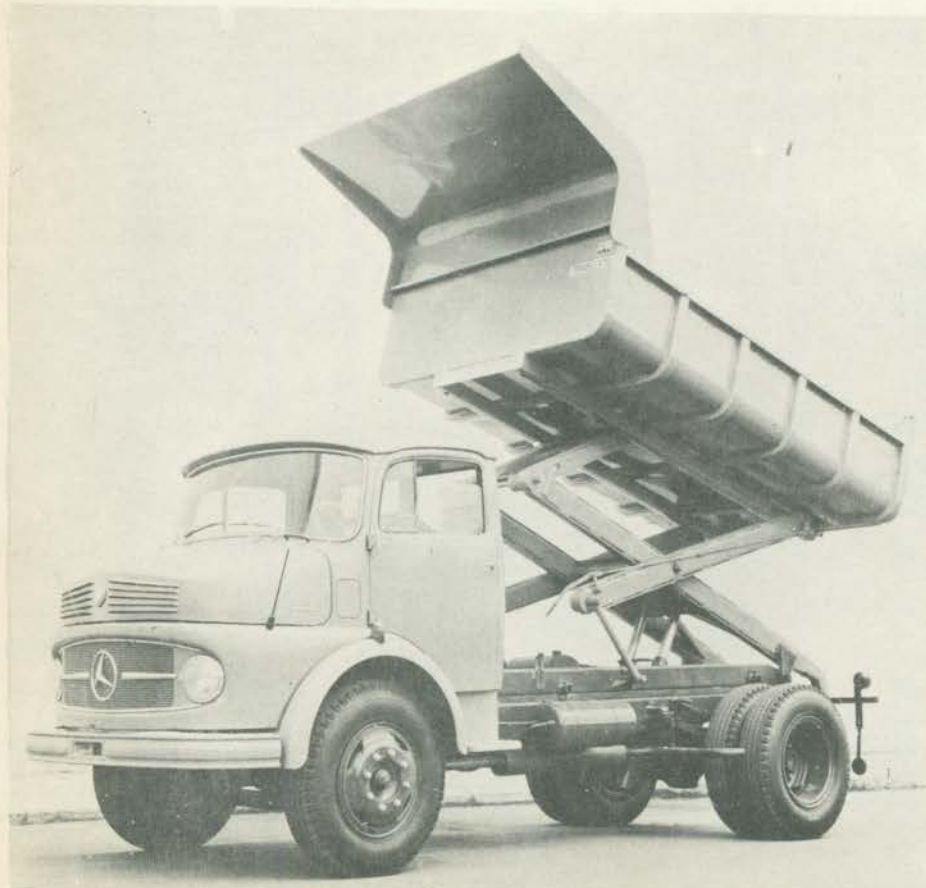
O modelo pantográfico permite a elevação da caçamba até 3,5 m de altura.
