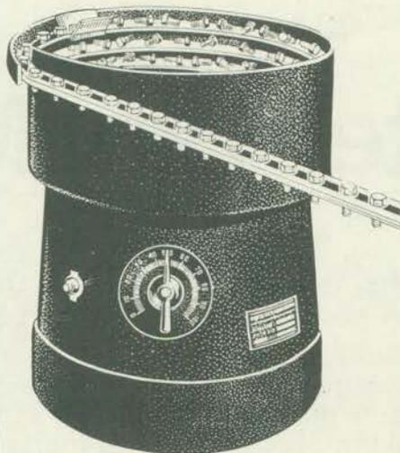
**ALIMENTADORES DE PEÇAS** — Acionado por vibradores eletromagnéticos, um alimentador de peças, tipo "tôrr", abastece automaticamente os mais variados modelos de máquinas, desde esmerilhadeiras até empacotadoras. Pregos, agulhas, comprimidos etc., já saem do alimentador na posição certa, para poderem entrar no equipamento a ser alimentado. **Serviço de Consulta n.º 2.**
