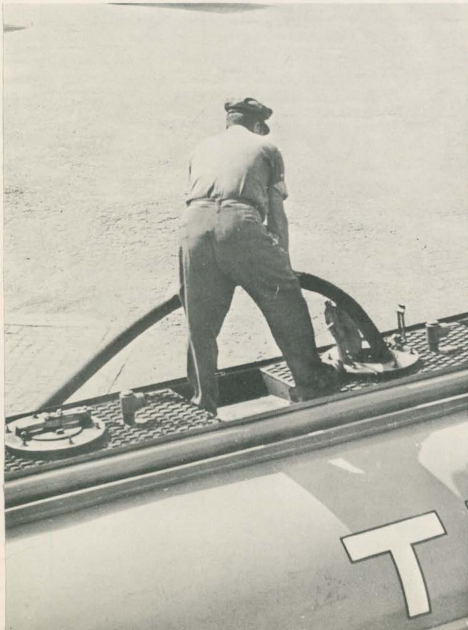
A aferição é indispensável para determinar com precisão a capacidade de um tanque. Pode ser feita de duas maneiras: a) enchendo-o de água, com volume determinado por recipientes-padrão de 500 e 1.000 litros de capacidade; b) comparando-se a tara com o peso bruto do caminhão-tanque. Este segundo processo é utilizado, em São Paulo, pelo Instituto de Pesquisas Tecnológicas.
