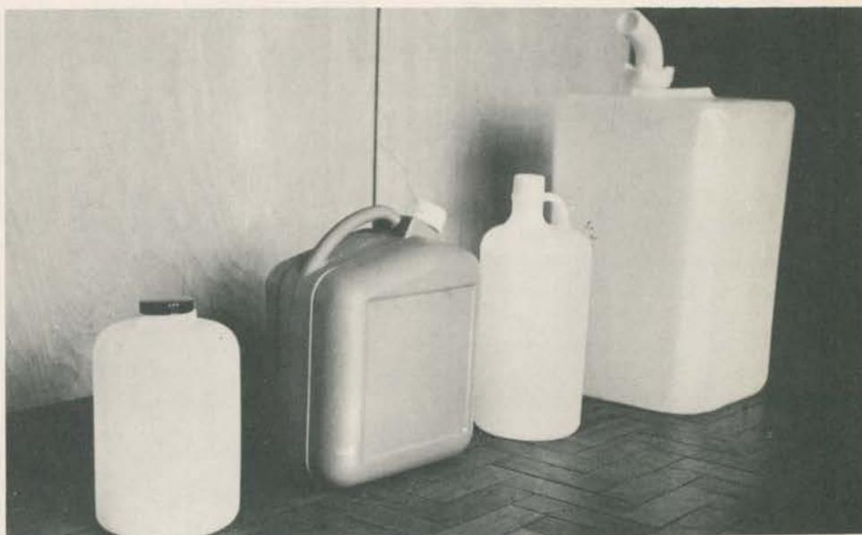
*Termocompressão* — Numa prensa, semelhante às utilizadas na indústria metalúrgica, aquece-se uma lâmina de polietileno que, ao receber o impacto, toma a forma do molde.
