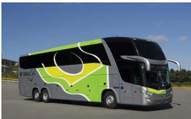
Os modelos Paradiso 1800 DD da Viação Garcia e Brasil Sul têm chassi Mercedes-Benz O500 RSD 6x2 e apresentam baixo custo operacional. Os veículos possuem poltronas semileito 1060 com descansapés/pernas no piso superior e leito-cama revestidas de couroflex e equipadas com monitor individual para cada passageiro, no piso inferior.
