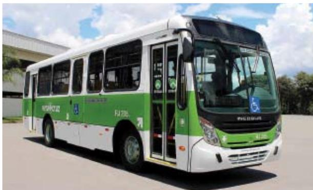
Mega Plus têm capacidade para 35 passageiros sentados. Possuem chassis Mercedes-Benz OF 1519 e estão equipados com elevador do tipo gaveta, faróis com máscara cromada e conjuntos óticos dianteiro e traseiro em LED, com iluminação diurna também em Led. Os ve-
