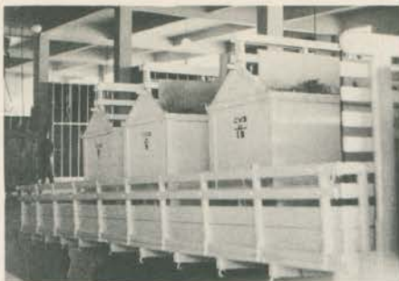
Caixas utilizadas para a estocagem do vidro servem também como containers.
