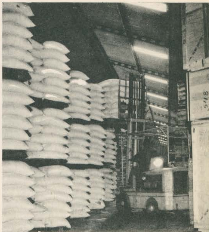
Dispondo os estrados com a inclinação de 45 graus, a Grumey S.A., do Rio, ganhou mais espaço em seus armazéns.
