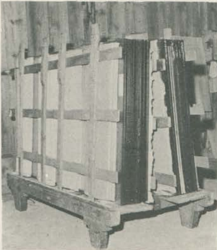
Cavaletes permitem armazenagem do vidro, com ângulos pouco inclinados.
