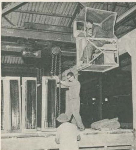
O uso de colares, no transporte por rodovia, diminui o índice de quebras.
