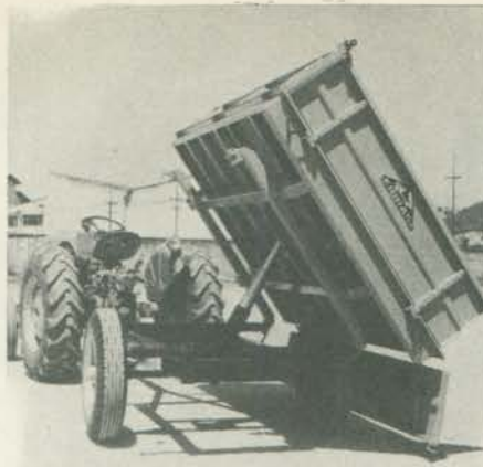
Carrêtas com basculação para os três lados permitem descargas mais rápidas.
