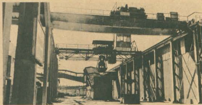
Ponte rolante tipo PE-2C-C, de 6 t x 15 m., com caçamba. Companhia Superfosfato e Produtos Químicos.
