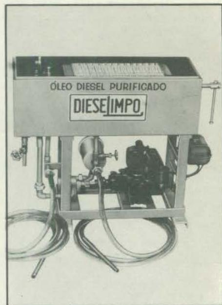
**DIESELIMPO** — Projetado especialmente para ser adaptado a comboios de lubrificação, o Dieselimpo MG/ST filtra o óleo diesel no momento em que se processa o abastecimento. Acionado por motor a gasolina de 2 1/2 CV, pesa 145 kg, medindo 1.080 mm de comprimento, por 920 mm de altura e 330 mm de largura. Pode ser fornecido sobre rodas. Serviço de Consulta n.º 4. ●
