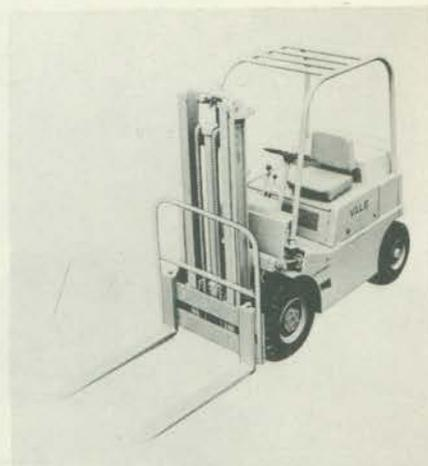
**EMPILHADEIRA YALE** — Ainda este ano, três modelos de empilhadeiras Yale G51P — 030, 040 e 050 — passarão a ser fabricados no Brasil, pela Eaton-Fuller Equipamentos Para Veículos Ltda. A capacidade máxima de carga para a G51P-030 é de 1.500 kg; para a G51P-040, de 2.000 kg; e para a G51P-050, de 2.300 kg. Os três tipos citados prontos para embarque, pesam respectivamente, 2.980 kg, 3.320 kg e 3.701 kg.
