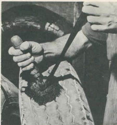
A borracha de ligação é colocada manualmente com o auxílio de um rolê.
