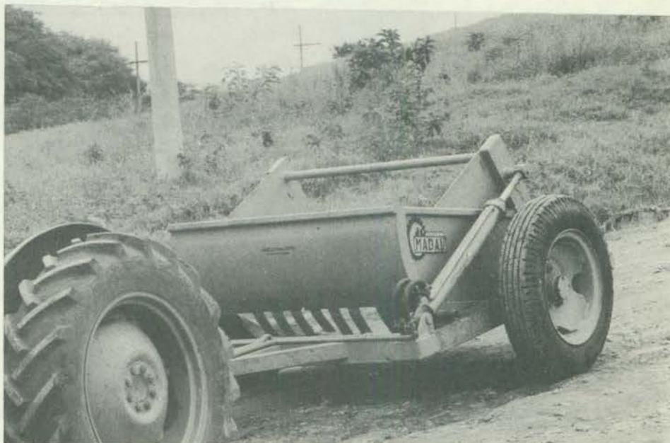
**RASPADEIRA** — Tractionável por tratores de rodas ou de esteiras, uma raspadeira cava, transporta e descarrega a terra com o simples acionamento de um comando hidráulico. Destina-se à construção de açudes, estradas e trabalhos de terraplenagem em geral. É fabricada em quatro modelos standard. **Serviço de Consulta n.º 8.**
