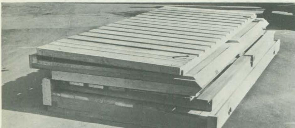
Quando desmontados, os containers têm a altura de apenas 25 centímetros.
