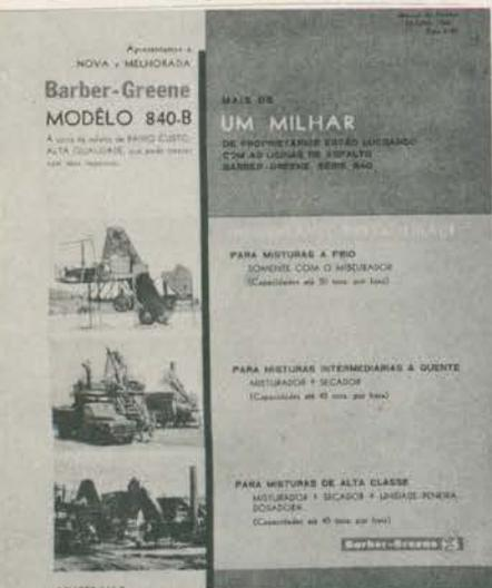
**USINAS DE ASFALTO** — A usina de asfalto modelo 840-B baseia-se no processo contínuo de dosagem e mistura, interligado aos sistemas de alimentação de agregado e asfalto. Suas características são explicadas em folheto ilustrado, publicado por sua fabricante, a Barber-Greene do Brasil, que produz, também, dezenas de outras máquinas rodoviárias. **Serviço de Consulta n.º 12.**
