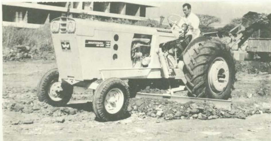
**MOTONIVELADORA** — Foi lançado no mercado o Manteiner DD-550. Trata-se de motoniveladora leve, equipada com lâmina de 12 x 150 x 2.750 mm. O motor, diesel, de 55 CV a 1.800 rpm, é refrigerado a ar e todos os comandos são hidráulicos. Pesando 4.300 kg, o equipamento presta-se para a manutenção de estradas e a execução de trabalhos de terraplenagem em geral. **Serviço de Consulta n.º 3.**
