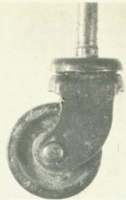
Rodízios giratórios têm os garfos curvos para facilitar as manobras. motorizados ou elétricos, para o transporte e manipulação das placas. O arquiteto José Alberto projetou, então, um carrinho de duas rodas pneumáticas, com 15 polegadas de diâmetro, especialmente para aquela finalidade. Havia necessidade, porém, de outro equipamento que, além de efetuar o transporte, facilitasse a montagem das casas, cujas paredes são constituídas de duas placas justapostas.
