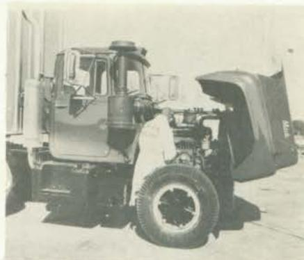
**CAPÔ DE VIDRO** — O capô do Mack modelo R é fabricado com fibra de vidro — leve, mas resistente a choques e corrosão — abrindo de forma a expor inteiramente o motor, radiador etc., facilitando inspeção e manutenção. O peso reduzido da fibra aumenta a capacidade de carga do veículo. O motor do novo Mack é vertical, tornando mais acessíveis a bomba injetora e o compressor. **Serviço de Consulta n.º 8.**
