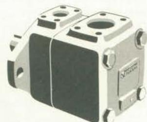
■ Bombas de Palhêtas. Balanceadas hidráulicamente. Suportam pressão de até 175 atmosferas e rotação até 2500 rpm. Permitem substituição do conjunto rotativo na própria máquina, sem necessidade de desligar os encanamentos.
