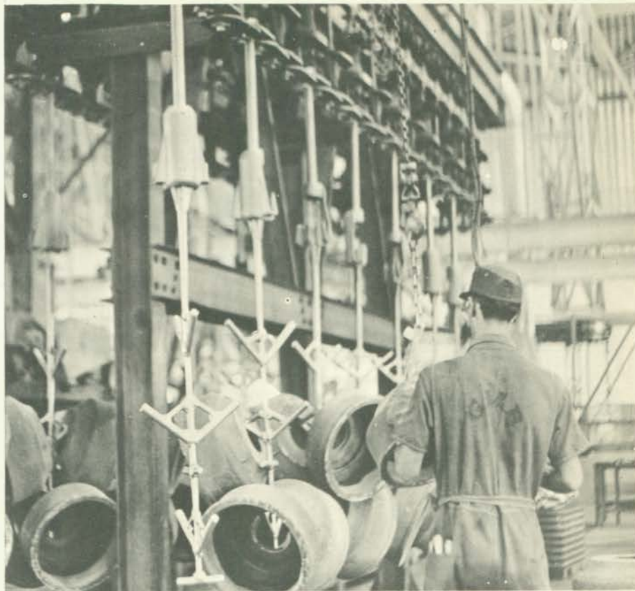
Transportadores de corrente conduzem fundidos na General Motors do Brasil.
