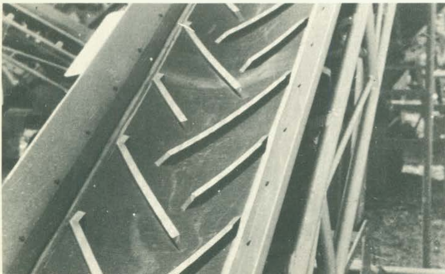
A Novatração apresenta correias com desenhos especiais para maiores inclinações.
