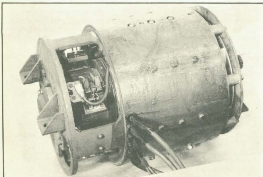
O motor Villares de 140 CV é o único que vem sendo utilizado nos tróleibus nacionais.
