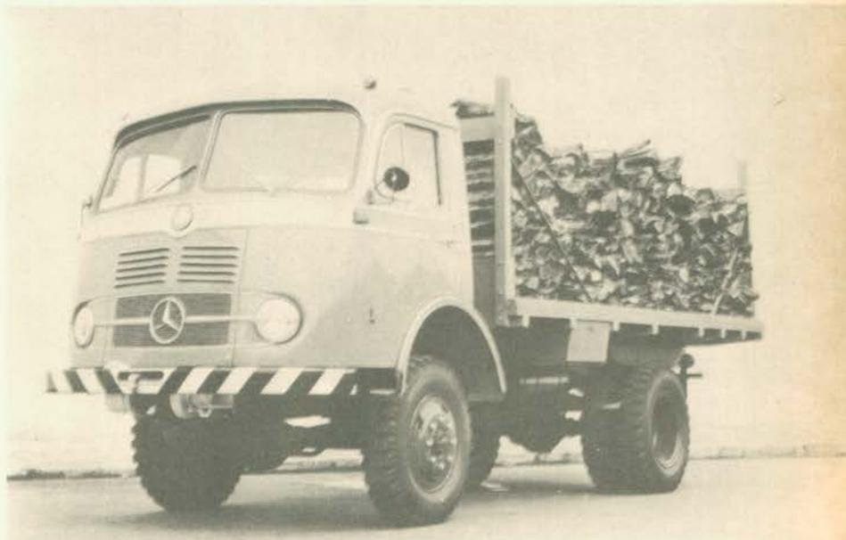
O LAP-321, da Mercedes-Benz do Brasil, é o único caminhão nacional com tração nas quatro rodas. Equipado com motor de 120 HP a 2.800 rpm, seis cilindros, destina-se, particularmente, à execução de tarefas rudes, em terrenos difíceis. Sua utilização possibilita o recolhimento de carga nos próprios locais de produção, mesmo fora da estrada. Possui cinco marchas sincronizadas à frente e uma à ré, com redução adicional na caixa de transferência. Seu peso total é de 10,5 toneladas.
