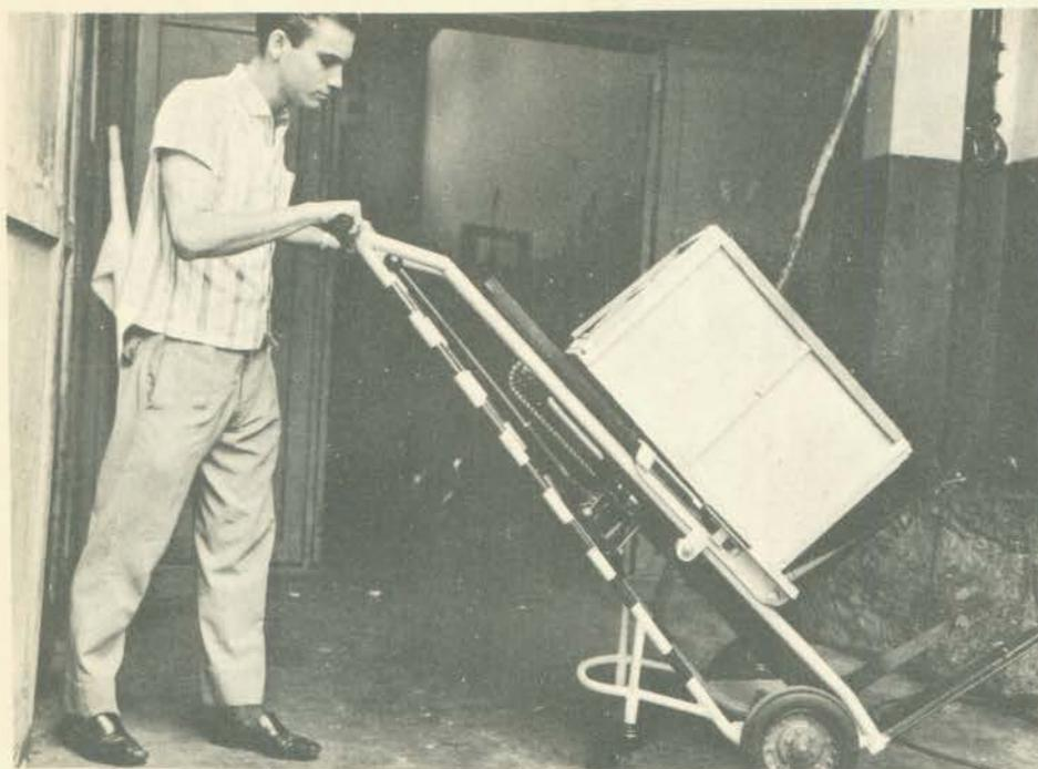
O carrinho-empilhadeira da Manejo pode ser equipado, opcionalmente, com plataforma, garfos para "pallets" ou gancho para rolos de arame, pesando até 200 kg.
