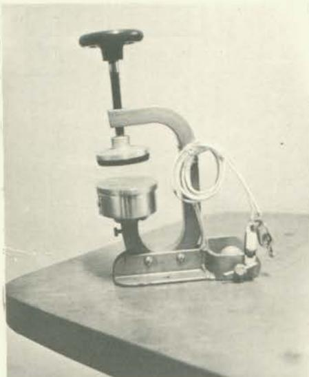
**VULCANIZADOR PORTÁTIL** — Um acidente na estrada com o pneu de um caminhão ou automóvel causa transtorno. Quando se necessita vulcanizar uma câmara de ar é preciso ir à cidade ou posto de serviço mais próximo. Com o intuito de solucionar esse problema foi lançado recentemente no mercado um moderno vulcanizador portátil. Fabricado pela Massi de Belo Horizonte, funciona ligado a uma bateria de 6 a 12 Volts. **Serviço de Consulta n.º 6.**
