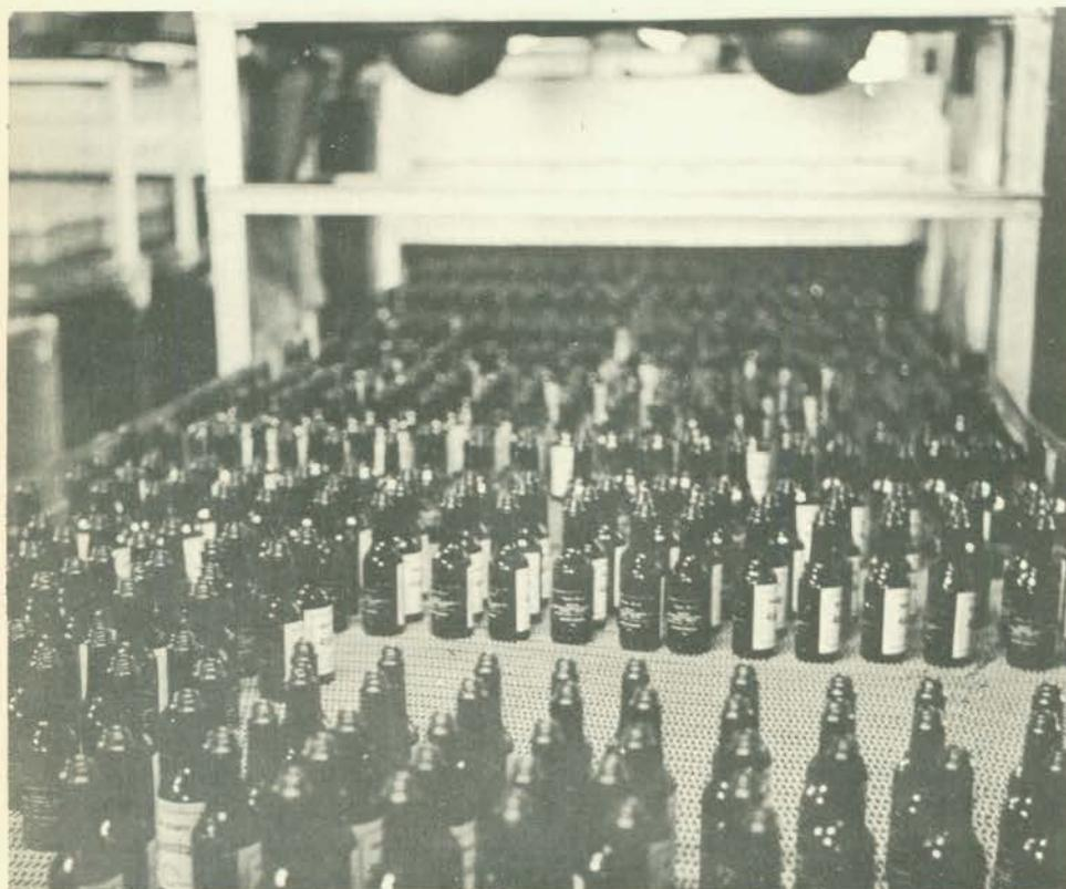
A Companhia Vidraria Santa Marina tem transportadores de tela metálica de 80 m x 1,50 m, utilizados para a "decoreção" de garrafas, à temperatura de 600°C.
