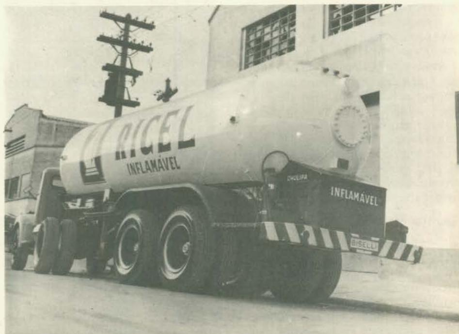
Para gás liquefeito de petróleo, os tanques necessitam ser superdimensionados.
