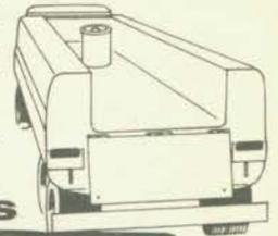
Semi-reboque ou tanque sobre chassis, carga mista, dupla finalidade.
