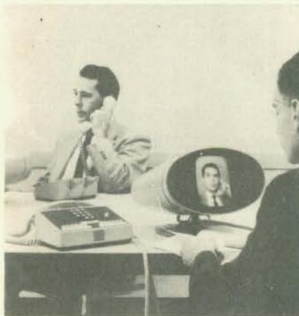
**PICTUREPHONE** — Um novo telefone, que permite, ao interlocutor, ver e ser visto, está sendo testado nos EUA. A transmissão de imagens é feita automaticamente, a partir do momento em que se completa a ligação. Fabricado pelo Bell System, da American Telephone and Telegraph Company, comporta três elementos: conjunto de câmara e tela; unidade de controle; e fonte de alimentação. Serviço de Consulta n.º 8.
