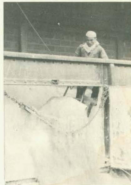
**PÁ ARRASTADORA** — Apenas um homem é capaz de descarregar até 30 toneladas por hora de produtos a granel, com o auxílio de uma pá arrastadora. O equipamento, fabricado pela Donar Ltda., de São Paulo, proporciona grande redução do custo de mão-de-obra e, em ferrovias, diminui o tempo de permanência dos vagões nos pátios de descarga. **Serviço de Consulta n.º 6.**
