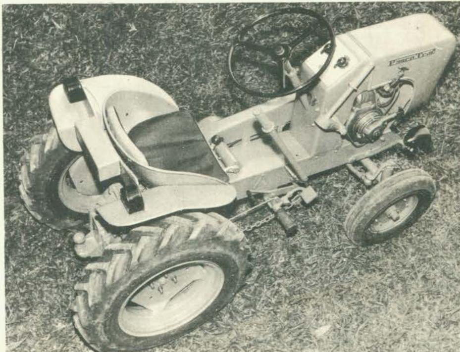
**MICROTRATOR** — Destinado a cumprir tarefas industriais e agrícolas e a realizar pequenos transportes, o microtrator Pasco MT-9 possui uma série de implementos que o tornam versátil e prático. Pesando 445 kg, pode tracionar até 315 kg. A potência do motor é de 9 HP a 4.500 r.p.m. e o consumo médio de combustível é de 1,25 l/hora. Fabricado pela Lambretta do Brasil. **Serviço de Consulta n.º 2.**
