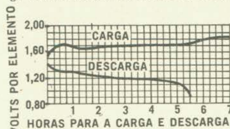
Gráfico II — Curvas de carga e descarga de um acumulador Edison, alcalino.
