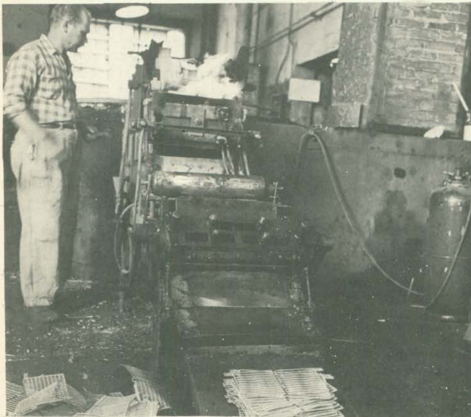
As placas negativas das modernas baterias ácidas são grades de chumbo, sôbre as quais, posteriormente, é aplicado peróxido de chumbo em forma de pasta.
