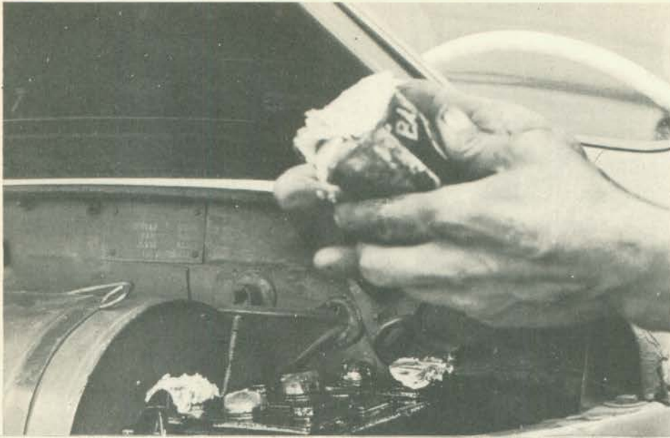
Embora seja comum impregnar de graxa os bornes das baterias, os fabricantes condenam essa prática, pois ela provoca o acúmulo de poeira e autodescarga.
