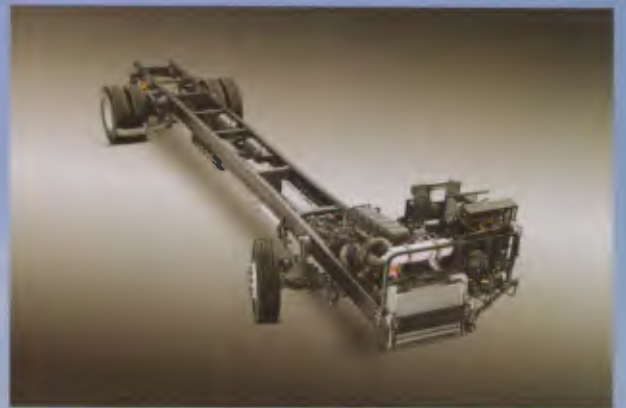
Chassi Scania da Linha F com motor dianteiro
