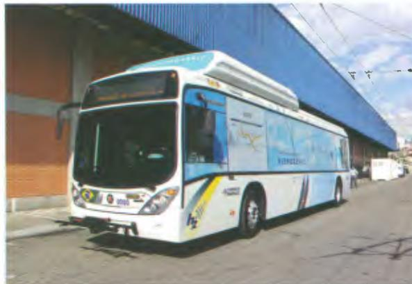
O novo ônibus movido a hidrogênio tem autonomia para rodar 340 km
