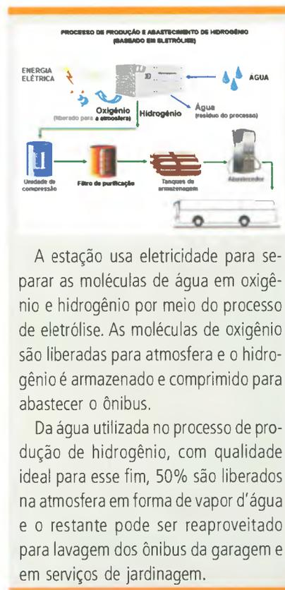
A estação usa eletricidade para separar as moléculas de água em oxigênio e hidrogênio por meio do processo de eletrólise. As moléculas de oxigênio são liberadas para atmosfera e o hidrogênio é armazenado e comprimido para abastecer o ônibus.
