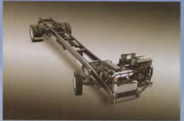
Chassi Scania da Linha F com motor dianteiro
