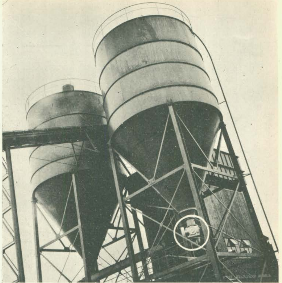
O cálculo indireto do conteúdo de silos pode ser feito, facilmente, com o emprego de uma célula de carga, de grande precisão, assinalada, na foto, por um círculo.
