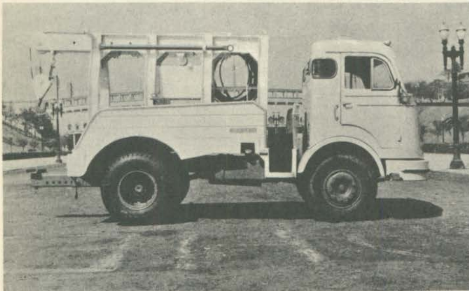
Para levantar até seis e tracionar 12 toneladas, há o guincho-elefante. A armação é em perfil "U", de chapa dobrada, com 3/8" de espessura para suporte da lança.
