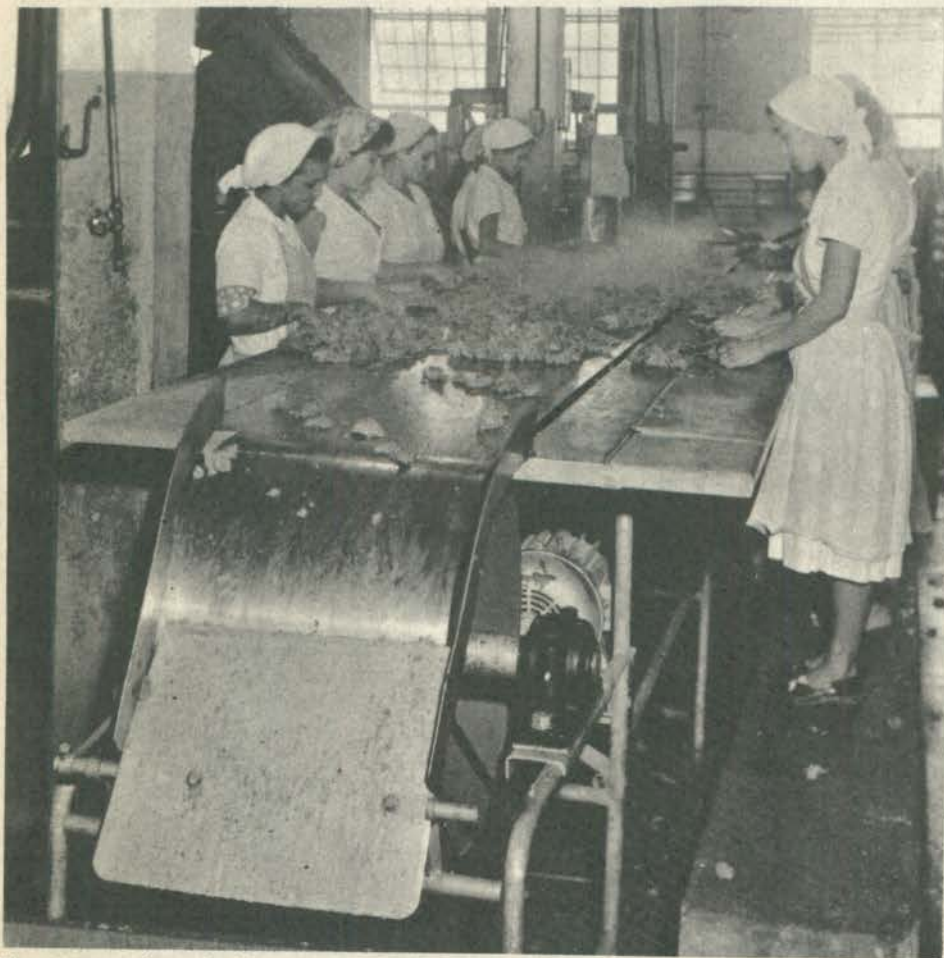
Nas mesas de trabalho, onde a higiene é um requisito essencial, a fita metálica tem papel fundamental. O transportador da foto funciona a baixa velocidade.
