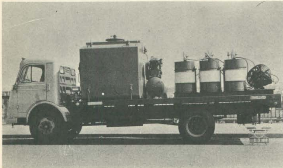
Se juntamente com o comboio de lubrificação, for instalado sobre o veículo um tanque e bomba para combustível, o equipamento terá eficiência muito maior.
