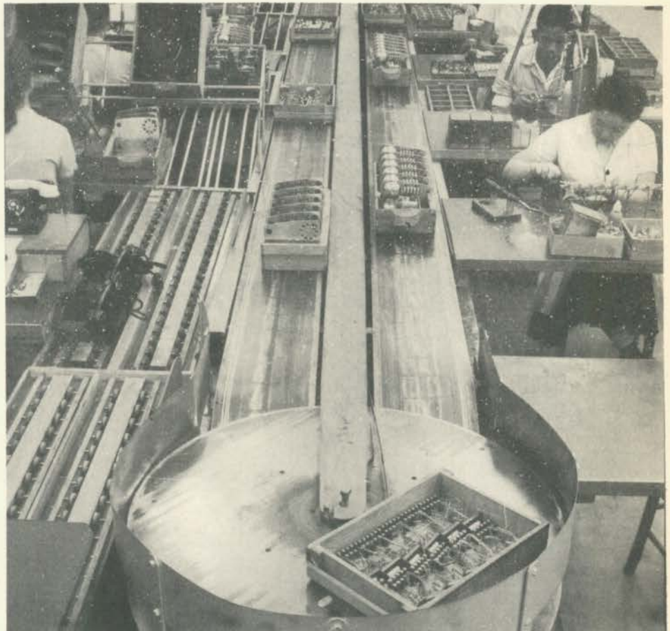
Linha de montagem que se acha instalada na Ericson — São José dos Campos. Compõe-se de duas fitas e um disco para inversão do sentido de movimento. ●
