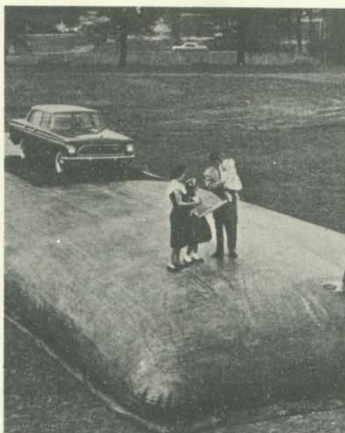
Depósito de combustível
