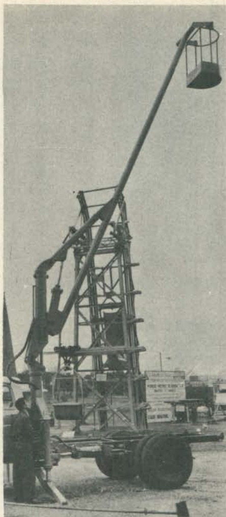
No guindauto, o extensor com caçamba serve para inspecionar cabos aéreos.
