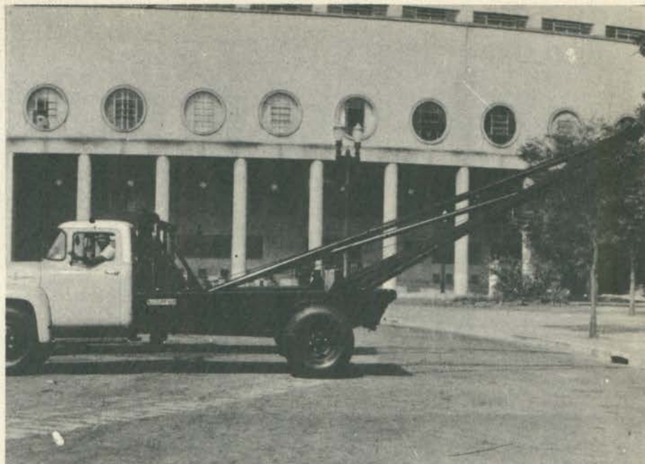
Também a Trivellato, entre outras indústrias nacionais de carroçarias, fornece equipamento para campos de petróleo: o guincho tipo refinaria é um exemplo.
