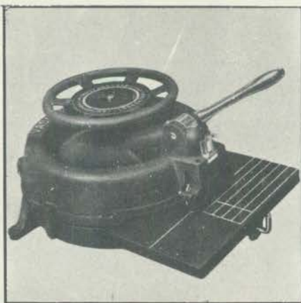
Máquina de recortar letreiros "Vascograf", fabricada pela D.F. Vasconcelos.
