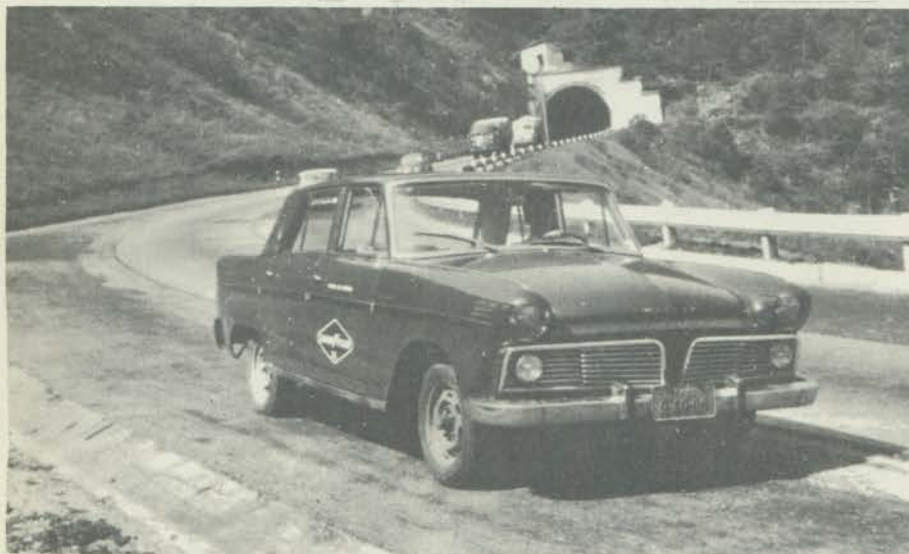
Algumas fábricas têm frotas próprias com a finalidade de "torturar" os pneumáticos. Veículos como este rodam 24 horas por dia, testando sua resistência.
