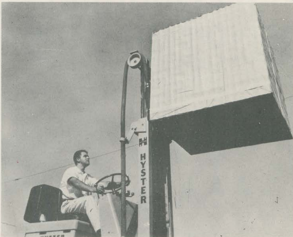
EMPILHADEIRA A VÁCUO — Máquina para retirar o ar de embalagem herméticamente fechada — e com a carga já acondicionada — foi lançada no setor de movimentação de materiais. A pressão atmosférica força o volume contra o quadro da empilhadeira, permitindo fácil movimentação e elevação. Serviço de Consulta n.º 19.
