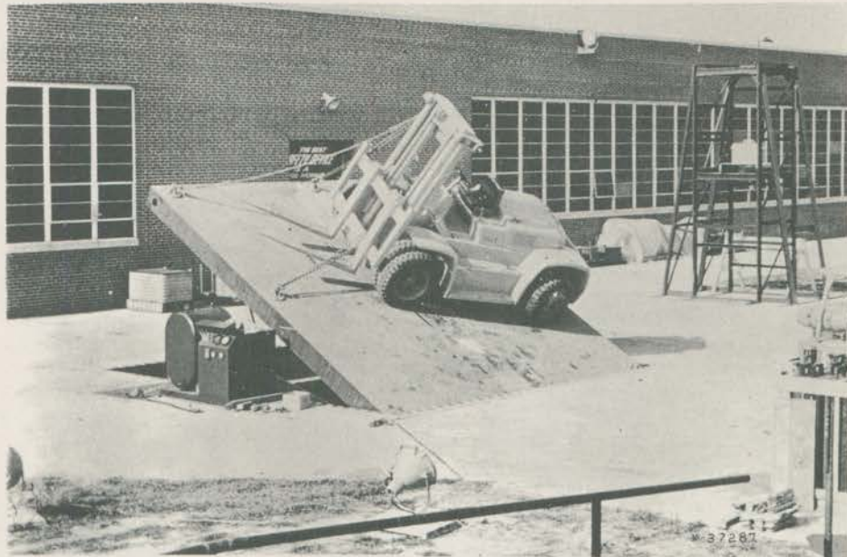
PLATAFORMA HIDRÁULICA — Uma empilhadeira passa por um teste de estabilidade, sobre uma plataforma de 20 m 2 , em plano inclinado, operada hidráulicamente. É submetida às mais adversas condições de trabalho. Serviço de Consulta n.º 17.
