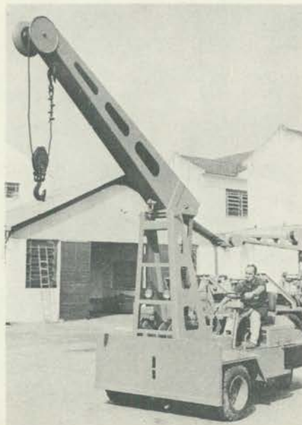
O guindaste Karri Go modelo GB, da Cia. Nacional de Guindastes, é equipado com motor nacional "Willys".
