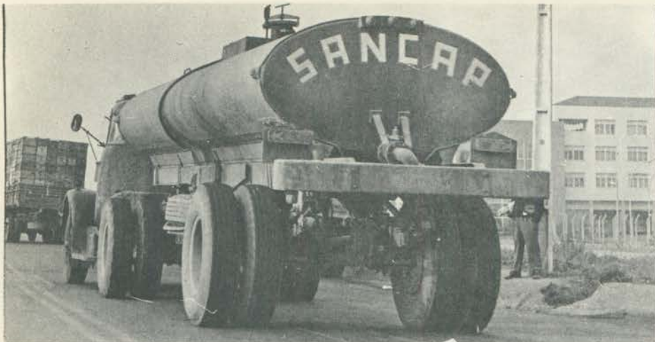
Uma abertura superior permite encher o tanque de água. A descarga é feita por meio de um registro localizado atrás, onde é adaptada uma mangueira.
