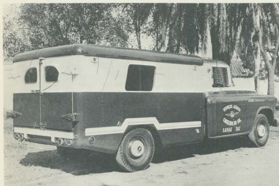
Este tipo menor, sobre o chassi de um Ford-100, destina-se ao transporte de malas aéreas, fazendo a ligação entre o aeroporto e agência de uma empresa de aviação.
