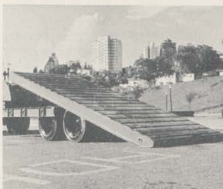
Para carga e descarga, o semi-reboque carrega-tudo tem plataforma inclinável e eixo duplo para maior resistência.
