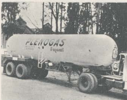
Gás liquefeito de petróleo exige tanque ultra-resistente. As válvulas protegem contra o excesso da pressão.
