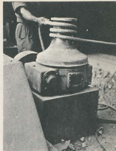
Arrastador de vagões em utilização na Companhia de Armazéns Gerais do Estado de São Paulo no Jaguaré.
