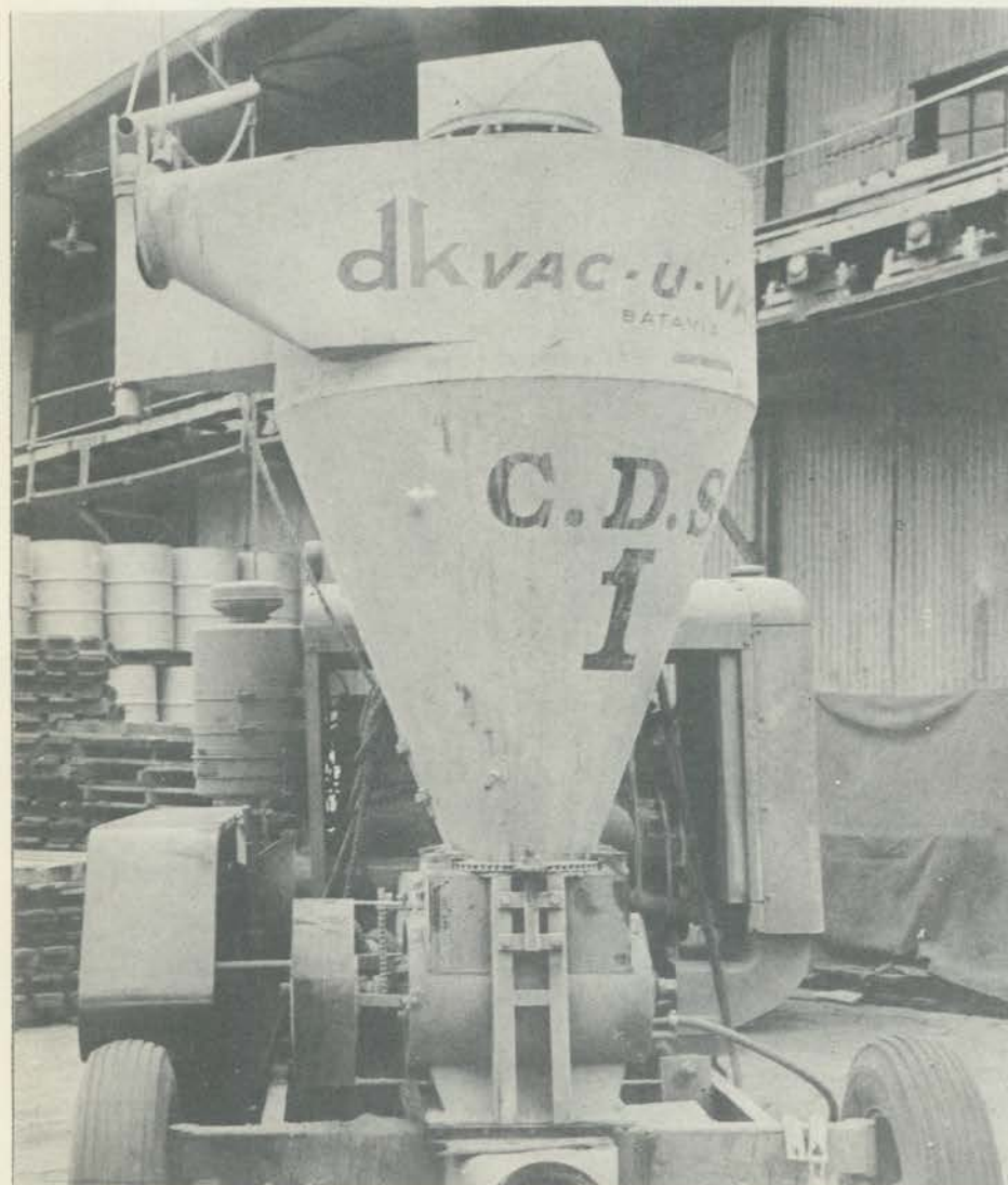
Um transportador pneumático portátil utilizado no carregamento de milho do pôrto de Santos. A Cia. Docas adquiriu quatro dées, para dinamizar suas operações.
