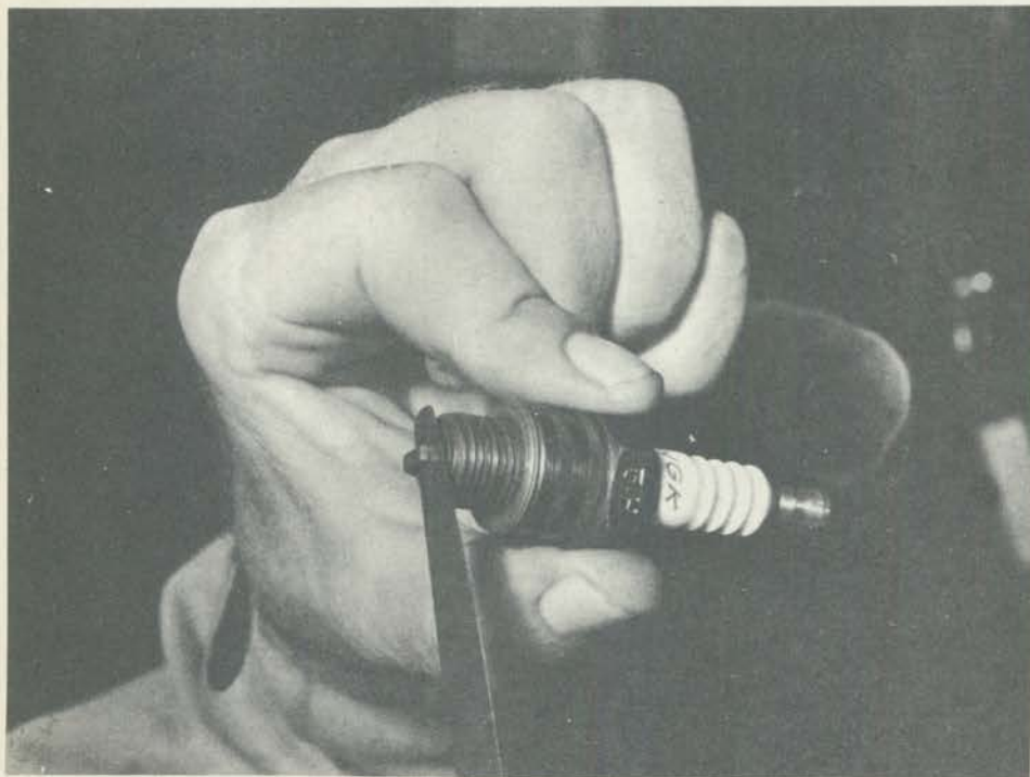
A ignição elétrica da mistura gasolina-ar, comprimida no cilindro, é feita pela vela.
