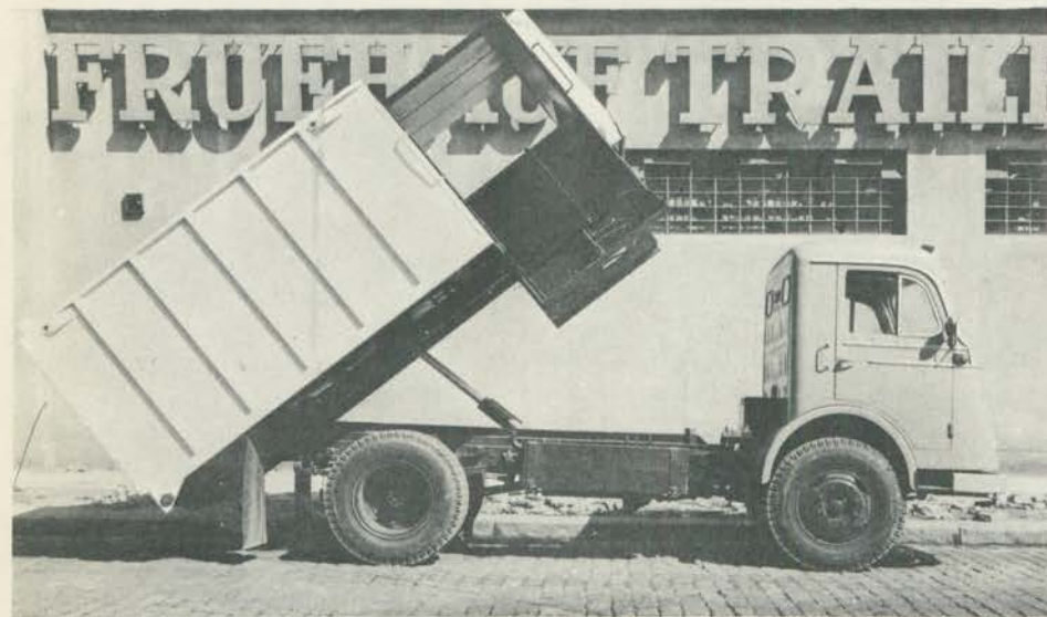
O Colecom — usado pelos serviços de limpeza urbana — permite comprimir o lixo, à medida que a coleta é feita, aumentando assim a capacidade de carga.
