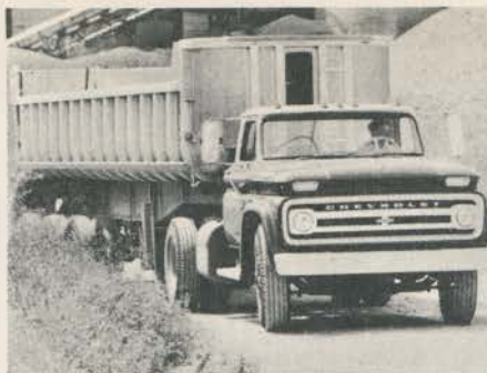
Esta caçamba é empregada, nos EUA, para o transporte de minérios, desde as jazidas até a usina de beneficiamento.
