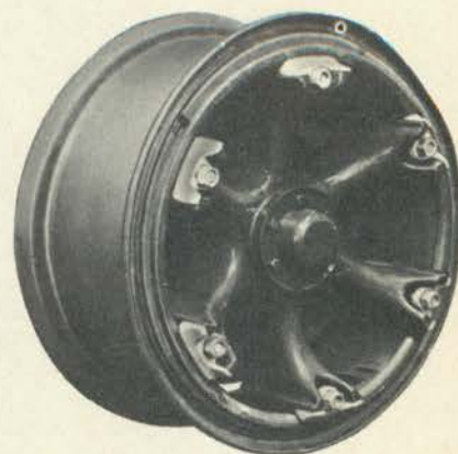
RODAS RAIADAS (PNEUS 11.00 x 22) Nos eixos dianteiro e traseiro. Levam melhor ventilação aos pneus e ao tambor de freio. Maior segurança de freagem e menor desgaste dos pneus.
