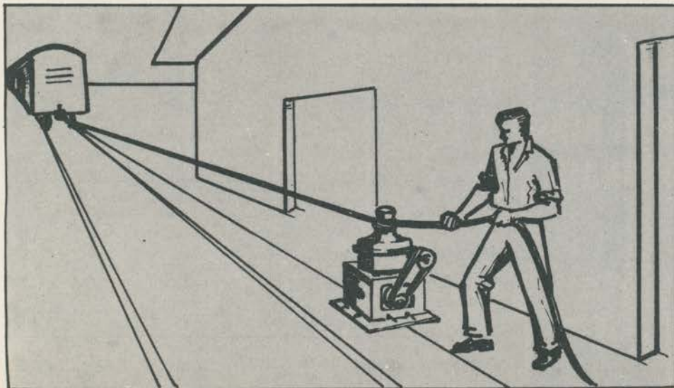
O arrastador compõe-se de um tambor acionado por motor elétrico e redutor. Enlaça-se a corda no tambor e mantém-se a aderência necessária ao funcionamento.
