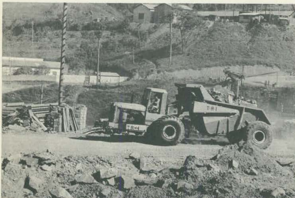
TRANSPORTADOR — Com aparência de um "moto-scraper" este veículo é usado apenas para transporte. É um "rear-dump", uma operação de descarga traseira.
