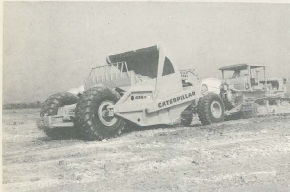
"SCRAPER" DESCARREGANDO — Note-se o avental levantado e a caçamba pairando pouco acima do solo. Este "scraper" é fabricado no Brasil pela Caterpillar.
