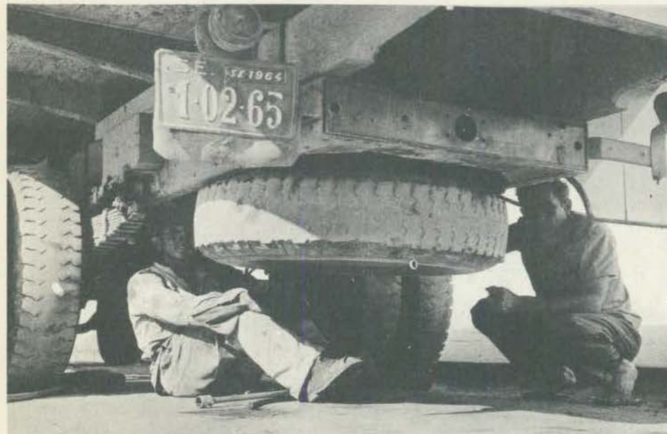
EXECUÇÃO — Isto conseguido, um segura a roda, enquanto outro coloca as porcas e aperta-as. O estepe já está no lugar certo e pronto para qualquer emergência.
