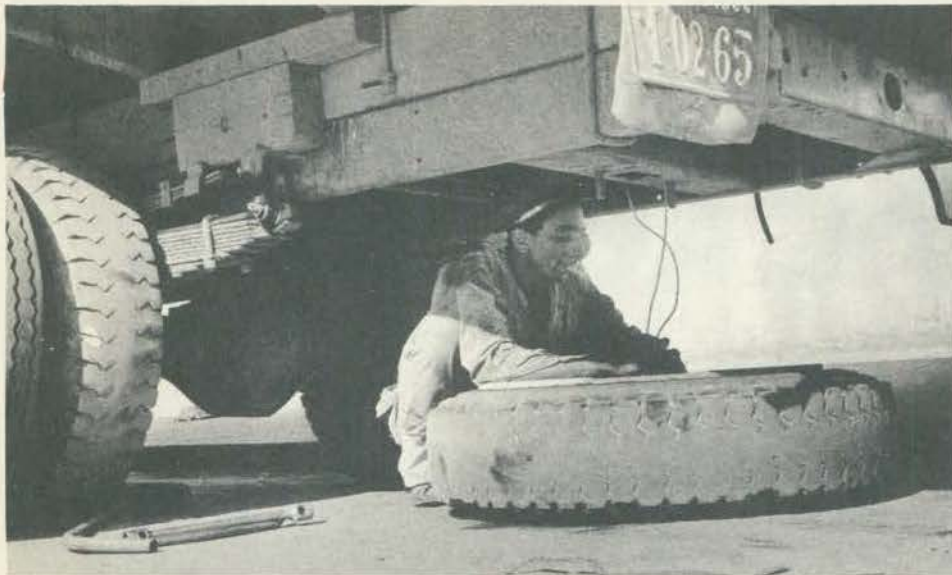
PREPARATIVO — O içamento do estepe começa assim. Um homem passa corda ou arame através dos orifícios do aro, que são destinados a receber parafusos.
