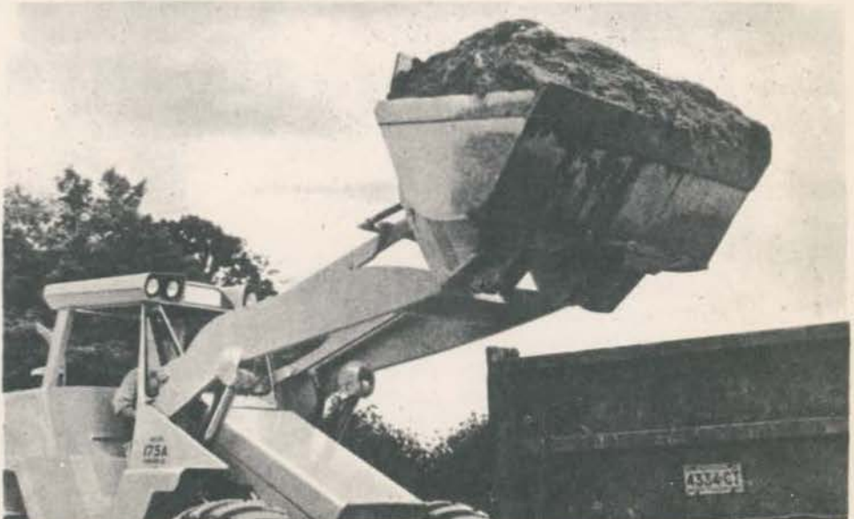
PÁ CARREGADEIRA — Este tipo é montado sobre rodas pneumáticas e vem sendo fabricado no Brasil pela Clark. É muito usado para trabalhos de terraplenagem.
