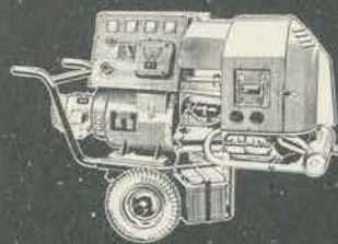
Grupo Gerador 18 KVA com Motor Industrial VOLKSWAGEN Corrente trifásica 220/127 Volts.
