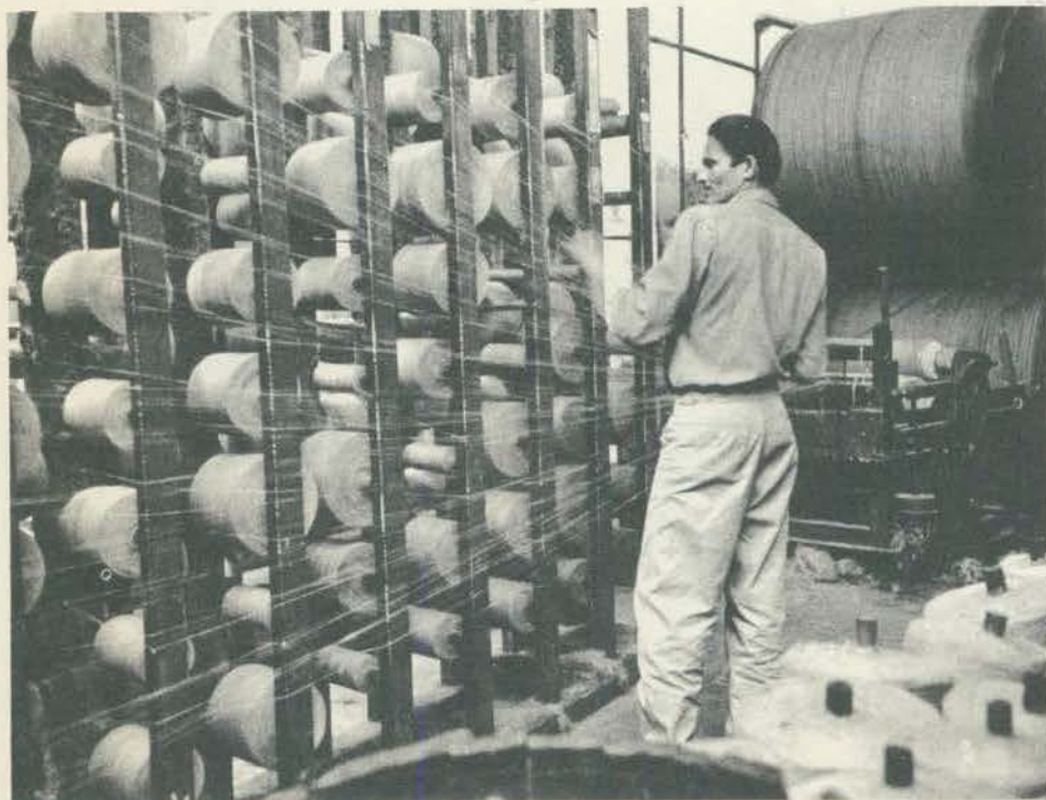
ENGOMAGEM — Depois de fiada, a fibra de juta passa por um processo de engomagem, destinado a lhe proporcionar maior resistência e melhor aspecto.
