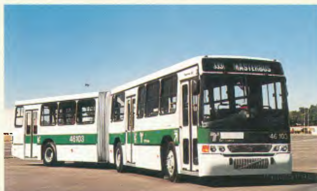
Modelo: Torino Articulado Aplicações: urbano Estrutura: tubular Peso: 8.480 kg Comp.: 18.150 mm Larg.: 2.500 mm Altura: 2.100 mm (interna), 3.220 mm (externa) Chassis que podem ser encarroçados: Scania e Volvo
