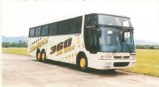
Modelo: Jum Buss 360 Aplicações: rodoviário Estrutura: alumínio Comp.: 13.200 mm e 14.000 mm Larg.: 2.600 mm Altura: 1.940 mm (interna), 3.610 mm (externa) Chassis que podem ser encarroçados: MBB, Volvo e Scania
