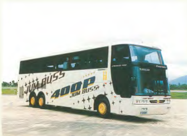
Modelo: Panorâmico Jum Buss 400 P Aplicações: rodoviário Estrutura: alumínio Comp.: 13.200 mm, 14.000 mm, 15.000 mm Larg.: 2.600 mm Altura: 1.940 mm (interna), 3.950 mm (externa) Chassis que podem ser encarroçados: MBB, Volvo e Scania
