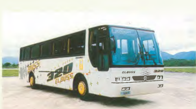
Modelo: EL Buss 320 Aplicações: rodoviário Estrutura: alumínio Comp.: 9.690 mm, 10.850 mm, 11.690 mm e 12.000 mm Larg.: 2.600 mm Altura: 1.940 mm (interna), 3.210 mm (externa) Chassis que podem ser encarroçados: MBB, VW e Ford
