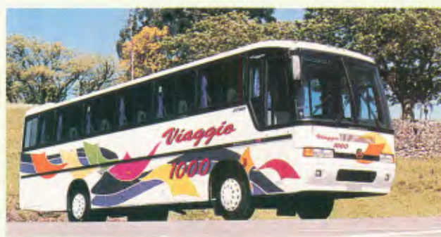
Modelo: Viaggio 1000 Aplicações: rodoviário Estrutura: tubular Peso: 5.900 kg Comp.: variável (12.000 mm/12.600 mm/13.200 mm) Larg.: 2.600 mm Altura: 1.930 mm (interna), 3.390 mm (externa) Chassis que podem ser encarroçados: MBB, Scania, VW, Volvo e Ford
