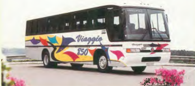
Modelo: Viaggio 850 Aplicações: rodoviário Estrutura: tubular Comp.: fornecido nas medidas 9.800 mm/ 10.870 mm/11.600 mm/12.000 mm Larg.: 2.600 mm Altura: 1.930 mm (interna), 3.340 mm (externa) Chassis que podem ser encarroçados: Scania, MBB, Volvo, VW e Ford
