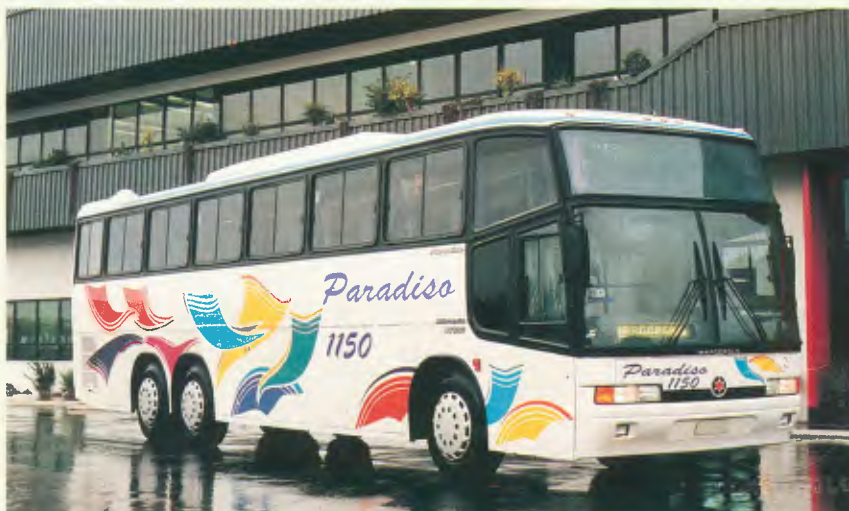
Modelo: Paradiso 1150 Aplicações: rodoviário Estrutura: tubular Peso: de 6.110 kg a 7.490 kg Comp.: de 12.000 mm a 14.000 mm Larg.: 2.600 mm Altura: 1.930 mm (interna), 3.690 mm (externa) Chassis que podem ser encarroçados: Scania, Volvo e MBB
