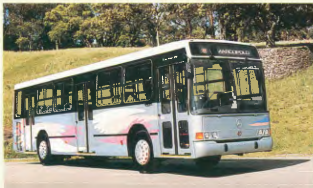
Modelo: Torino Aplicações: urbano Estrutura: tubular Peso: variável (4.010 kg, 4.050 kg, 4.330 kg, 4.810 kg, 4.890 kg, 5.035 kg e 5.275 kg) Comp.: 10.485 mm Larg.: 2.500 mm Altura total: 2.100 mm Chassis que podem ser encarroçados: MBB, Volkswagen, Ford, Scania e Volvo
