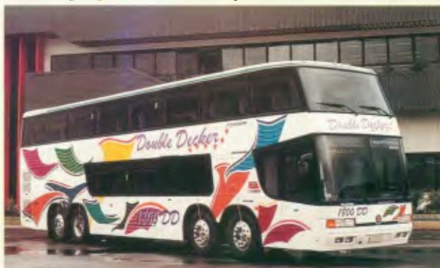
Modelo: Paradiso - Double Decker Aplicações: rodoviário Estrutura: tubular Peso: 9.370 kg Comp.: 14.000 mm Larg.: 2.600 mm Altura: 1.760 mm (interna), 4.100 mm (externa) Chassis que podem ser encarroçados: Scania K 113 TL 8x2
