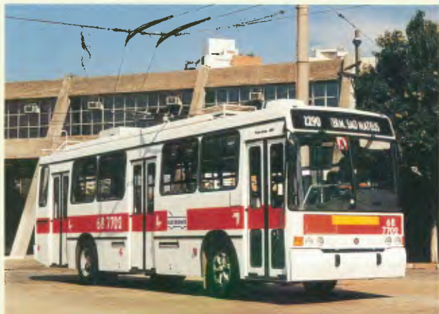
Modelo: Torino Trólebus Aplicações: urbano Estrutura: tubular Comp.: variável (4.010 mm/4.330 mm) 4.810 mm, 4.890 mm, 5.035 mm, 5.275 mm Larg.: 2.500 mm Altura: 2.100 mm (interna), 3.175 mm (externa) Chassis que podem ser encarroçados: Scania, MBB, Volvo, VW e Ford
