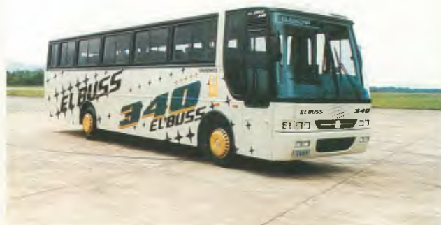
Modelo: EL Buss 340 Aplicações: rodoviário Estrutura: alumínio Comp.: 10.850 mm a 11.690 mm (foto), 12.000 mm e 12.890 mm, 13.200 mm e 14.000 mm Larg.: 2.600 mm Altura: 1.940 mm (interna), 3.410 mm (externa) Chassis que podem ser encarroçados: Scania, MBB e Volvo
