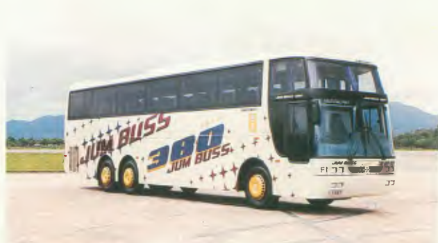
Modelo: Jum Buss 380 Aplicações: rodoviário Estrutura: alumínio Comp.: 13.200 mm e 14.000 mm Larg.: 2.600 mm Altura: 1.940 mm (interna), 3.810 mm (externa) Chassis que podem ser encarroçados: Scania, MBB e Volvo
