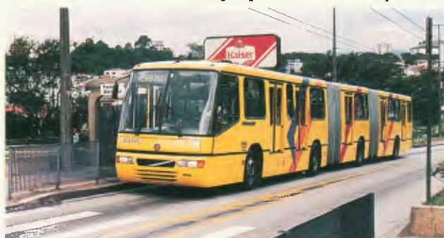
Modelo: Torino Biarticulado Aplicações: urbano Estrutura: tubular Peso: 9.910 kg Comp.: 24.900 mm Larg.: 2.500 mm Altura: 2.100 mm (interna), 3.220 mm (externa) Chassis que podem ser encarroçados: Volvo B 58 E
