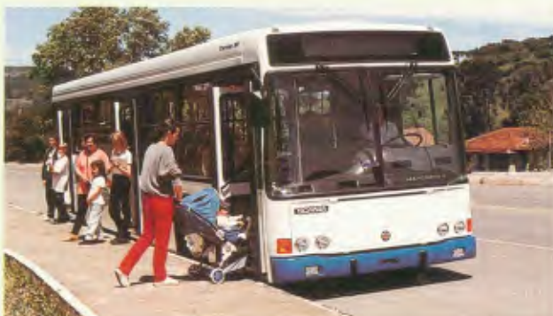
Modelo: Torino GV Aplicações: urbano Estrutura: tubular Peso: 5.275 kg Comp.: 13.200 mm Larg.: 2.500 mm Piso baixo: altura mínima 350 mm; altura máxima 600 mm Chassis que podem ser encarroçados: Scania L 113CLL importado (foto)
