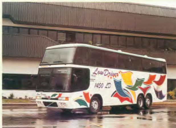
Modelo: Paradiso 1.450 - Low Driver Aplicações: rodoviário Estrutura: tubular Peso: 7.810 kg Comp.: 14.000 mm Larg.: 2.600 mm Altura: 1.930 mm (interna), 3.940 mm (externa) Chassis que podem ser encarroçados: Scania, MBF, Volvo
