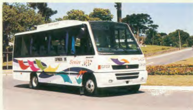
Modelo: Micro Torino Senior GV Aplicações: escolar Estrutura: tubular Peso: 2.210 kg Comp.: 8.085 mm Larg.: 2.240 mm Altura: 1.920 mm (interna), 2.780 mm (ext.) Chassis que podem ser encarroçados: MBB LO 812, OF 812 e VW7110
