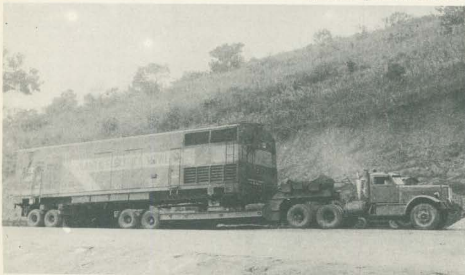
GERADOR — Mediante uma adaptação, na plataforma, a Cavalcanti Junqueira transportou grupos geradores entre Belo Horizonte e Vitória. O peso era de 75 t., cada.
