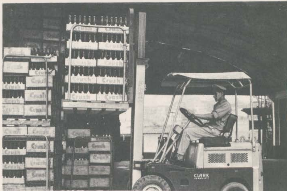
AÇÃO — A empilhadeira recolhe um estrado. Em fração de minuto, estará de volta para recolher outro. Carga e descarga são feitas assim, ininterruptamente.
