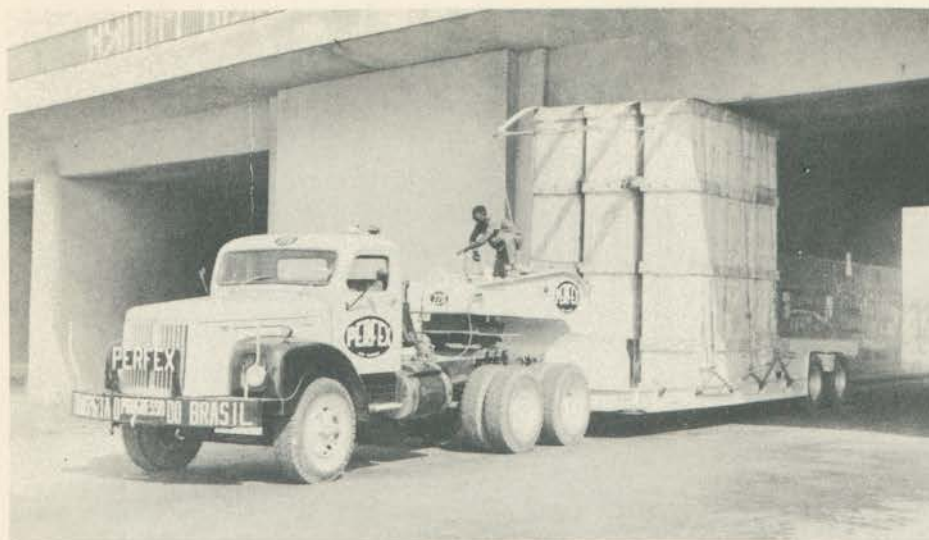
EMERGÊNCIA — Muitas vezes, a redução da altura da plataforma permite passar sob viadutos. Uma alternativa a que o motorista da Cia. Perfex recorre, na foto.
