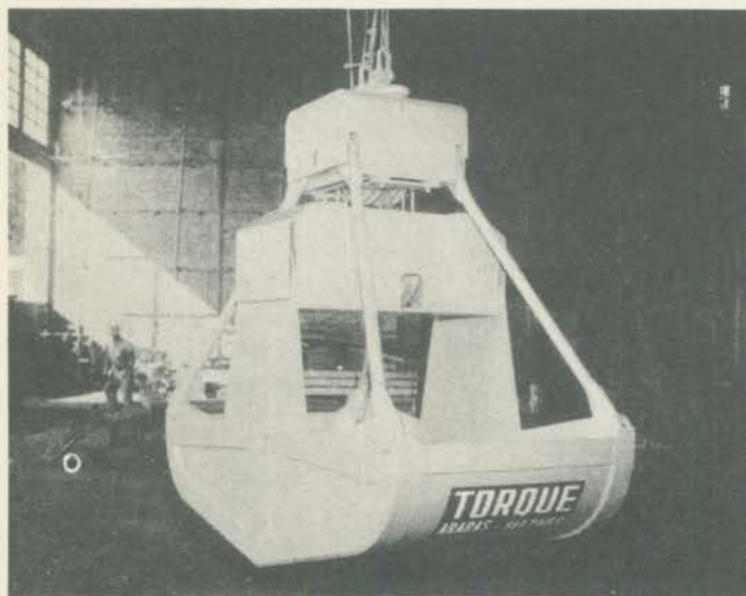
Clam Schell usado em fábrica de cimento, com capacidade de 2½ metros cúbicos
