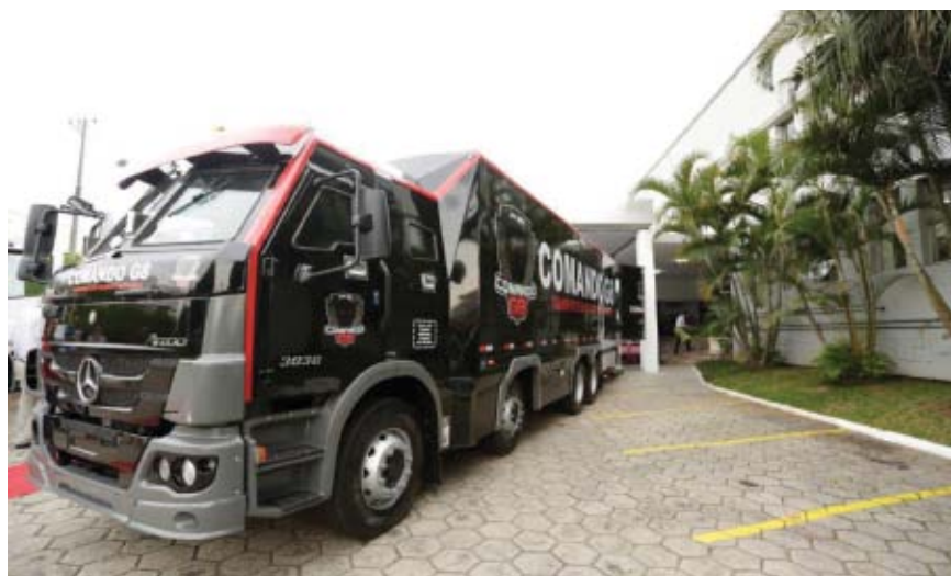
O Atego 3030 pode receber até quatro tripulantes na cabine, que tem blindagem de nível III
