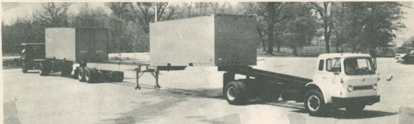
**FLEXIBILIDADE** — Ao chegar na terminal, a unidade de 13 metros é rapidamente partida em dois corpos de 6,50 metros. Cada "container" é enganchado num cavalo-mecânico e segue o seu destino. O máximo, em simplicidade operacional.
