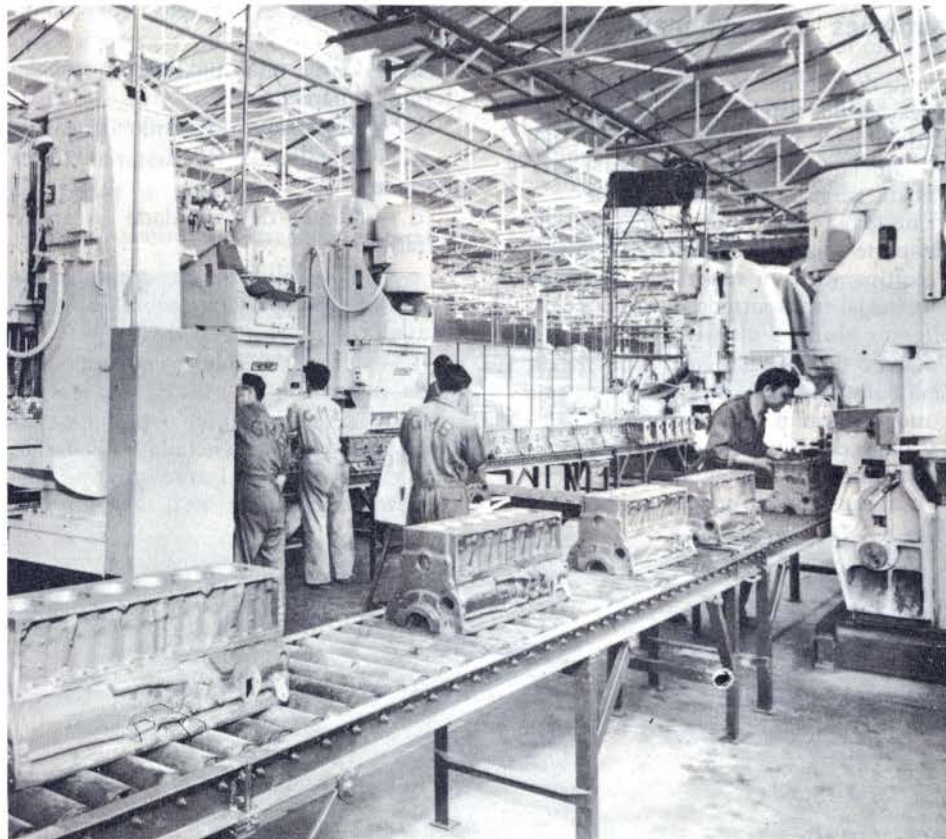
NA LINHA — Os roletes planos vêm sendo utilizados especialmente em sistemas do tipo linha de montagem. Colocados ao longo de um sistema assim, os operários podem processar as diversas operações requeridas sem a menor perda de tempo.
