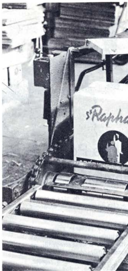
FACILIDADE — Caixas de papelão são boas. Movimentam-se com facilidade, sobre roletes livres, por gravidade.
