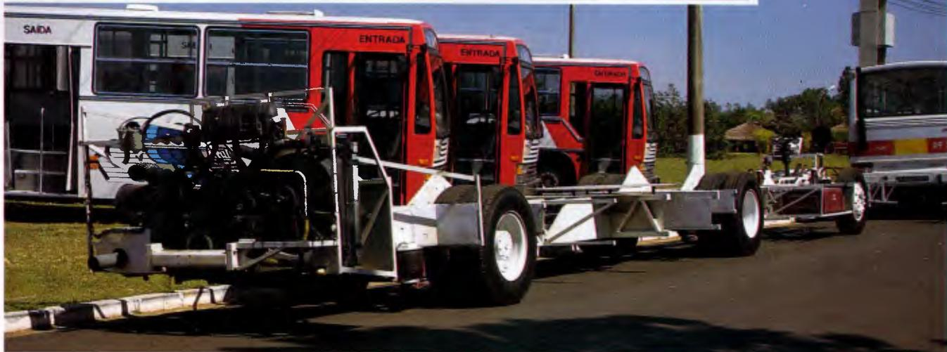
articulado complementa a linha da fábrica de Campinas; tem uma tecnologia já testada; mede 0,75 m na altura do solo ao piso, 0,20 m menos em relação à altura de um chassi. Outra vantagem da plataforma é seu peso, menor que o do chassi.
