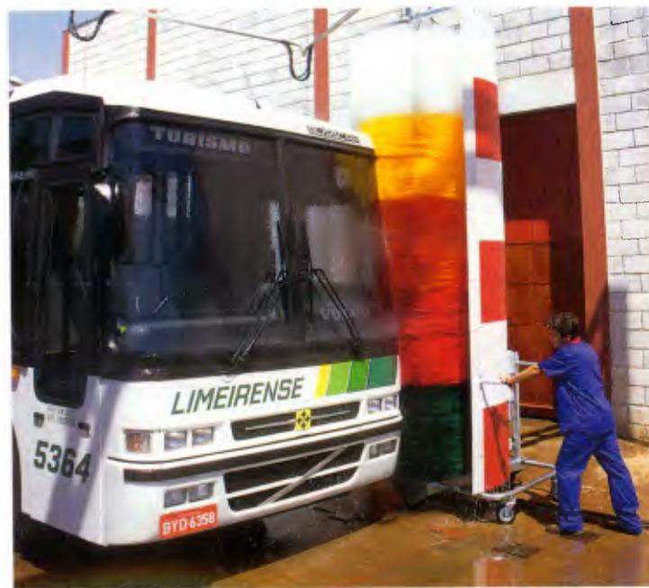
*O Rotomóvel foi idealizado para pequenas frotas. É uma máquina que usa pouco espaço, pouca água, pouca energia e lava um ônibus ou baú em 3 minutos. A própria escova, traciona a máquina ao redor do veículo, restando ao operador o trabalho de guiar o equipamento.*
