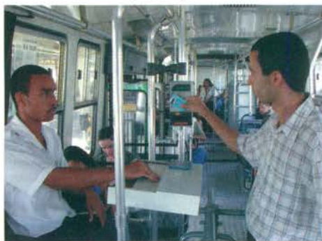
Leitura do smart card sem contato demora 1,2 segundo
