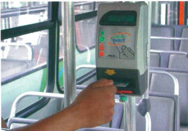
Validador ControlCIT instalado em 3 mil ônibus da frota
