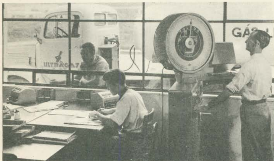
AUXILIAR — O faturamento da Refinaria Presidente Bernardes é feito com base nos dados indicados pela balança. Pesa-se o caminhão vazio e depois o caminhão cheio. A diferença é o "a pagar". A balança trabalha como auxiliar ativo.
