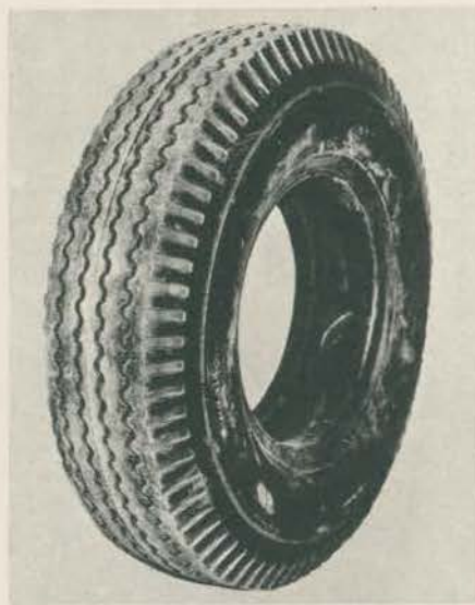
EXPRESSO Pirelli. Como os outros simples, bom para o asfalto e para rodagens dianteiras. Quatro raias paralelas, em zigue-zague suave no sentido da curvatura do pneu. Taquinhos rasos na bordas. Quando de 14 lonas (assim como os de outras marcas) suporta o mesmo peso que os borrachudos. Para informações, marque o n.º 16 do Serviço de Consulta.
