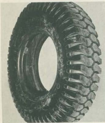
SUPER-TRAÇÃO U.S. Royal. 14 lonas. Travas altas e curvas que vão da lateral ao centro da banda, separadas por uma nervura circunferencial no meio. Típico "lameiro", deve ser operado fora do asfalto e à velocidade máxima (válida para os borrachudos) de 60 km horários. Para informações, marque o n.º 18 do Serviço de Consulta.
