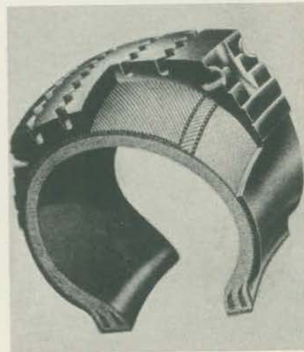
O LADO ÍNTIMO Um corte de carcaça de pneu mostrando suas três partes indispensáveis. Em baixo, os talões (fios de aço cobertos de borracha) que sustentam a carcaça. Depois, as lonas (de um composto de nylon, raion e borracha) e por cima, a banda de rodagem mostrando a formação de seu desenho característico.
