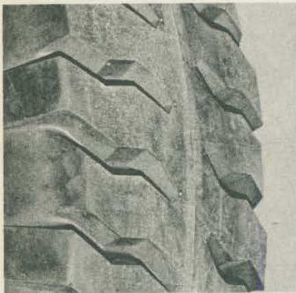
HCT General. Desenho de cortes rasos, porém, largos nas laterais, para tração e no centro da banda duas linhas de nervuras em zigue-zague acompanhando a curvatura do pneu para dar aderência e estabilidade. Para informações, marque o n.º 22 do Serviço de Consulta.
