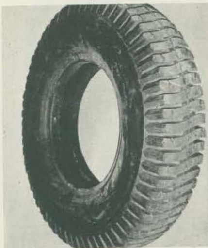
TOPA-TUDO Goodrich. Lameiro: desenho de travas altas que atravessam a banda de lado a lado. Nervuras sobre os gomos. Para estrada sem asfalto. Para informações, marque o n.º 19 do Serviço de Consulta.
