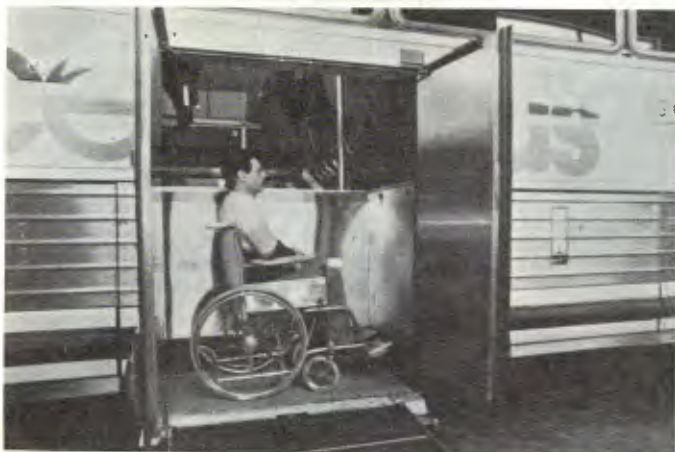
O deficiente fixa a cadeira no piso e viaja em local próprio
