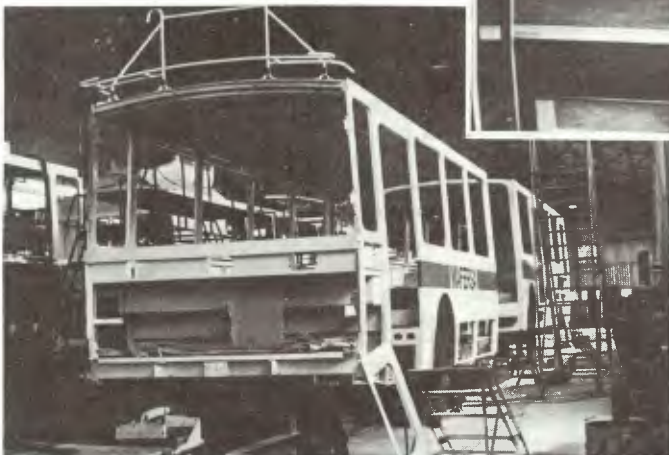
Sobre cavaletes, os módulos recebem acabamento
