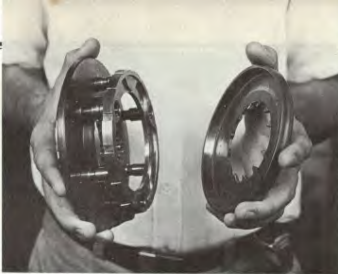
O sincronizador da Clark tem pista em aço molibdênio
