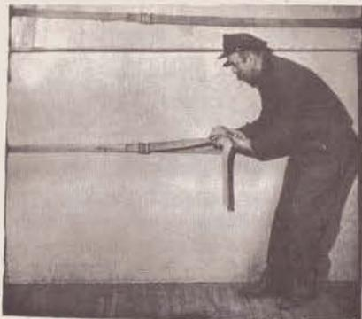
**A OPERAÇÃO** — Sòmente alguns segundos para a amarração da carga. Apenas um puxão e a carga está presa. Para soltá-la basta pressionar a fivela do cinturão.
