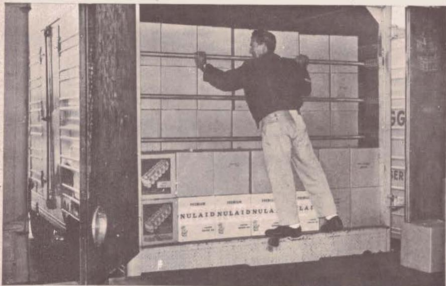
**BARRAS** — A Série F, do "Aeroquip" é empregada nos veículos de entregas rápidas, pois auxilia a separação de mercadorias diversas no interior da carroceria.
