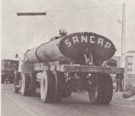
ASFALTO QUENTE — Carroceria para asfalto tem dispositivo para mantê-lo líquido. Serviço de Consulta, n.º 24.
