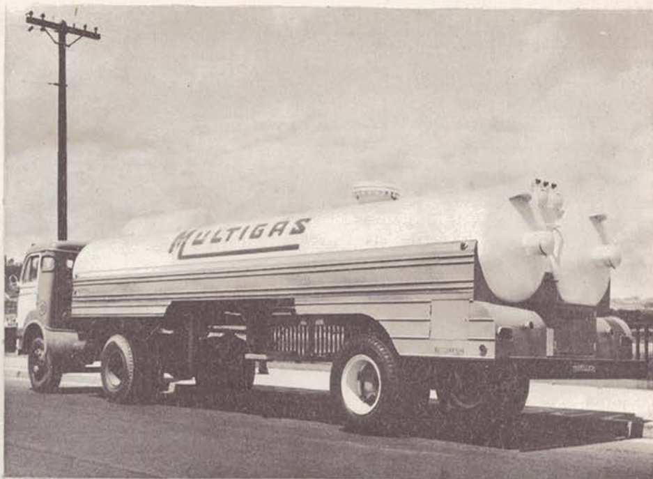
GÁS TEM SEGURANÇA — Válvulas de segurança asseguram o transporte de gás que é feito em tubos de grande resistência. Serviço de Consulta, n.º 25.
