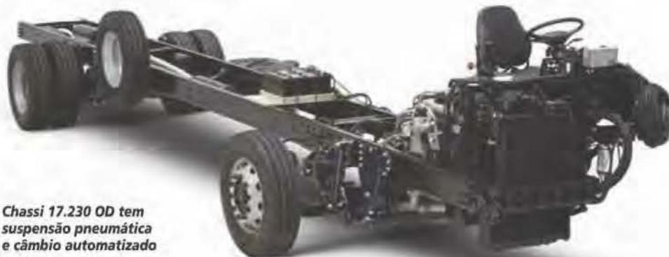
**Chassi 17.230 OD tem suspensão pneumática e câmbio automatizado**
