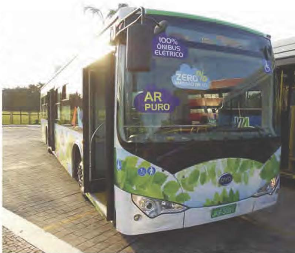
O ônibus elétrico BYD K9 tem chassi piso baixo e carroceria de 12 m de comprimento
