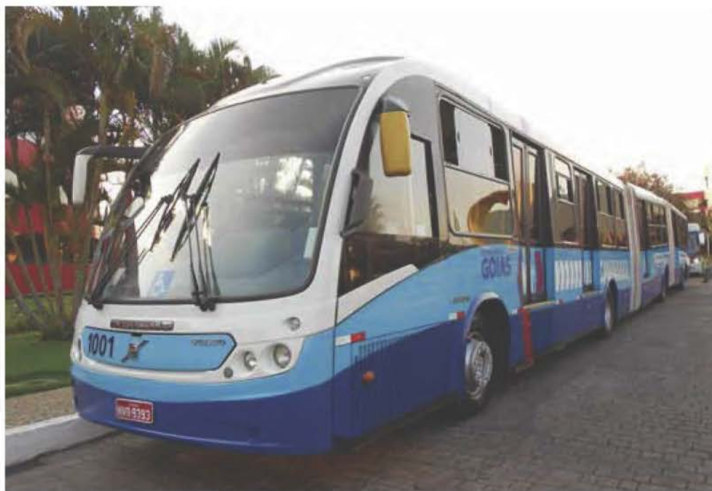
Indicado para BRTs, o biarticulado Volvo com carroceria Neobus transporta 270 passageiros
