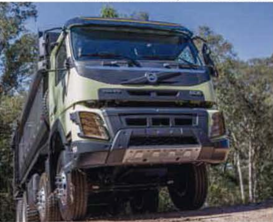
O FMX 8x4 tem 50 mm a mais de altura entre o eixo e o solo e suspensão mais robusta
