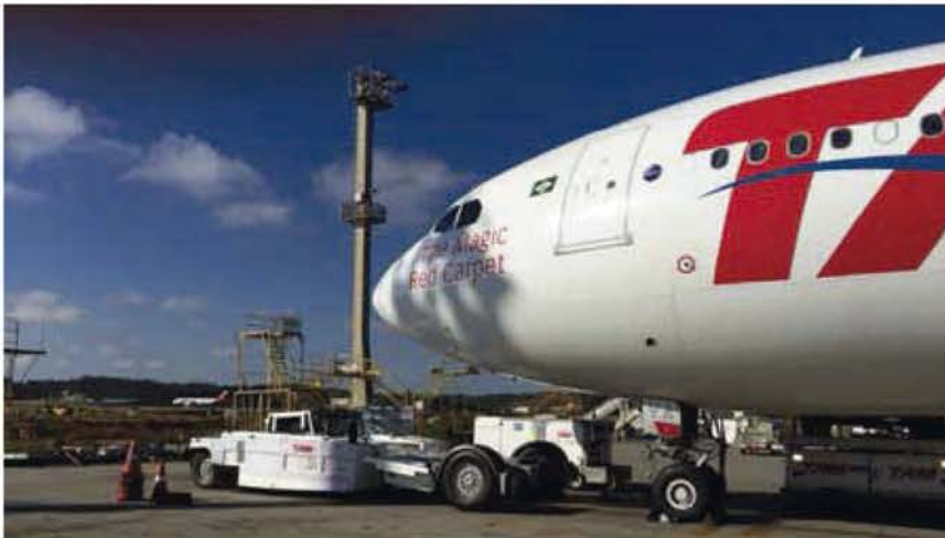
O rebocador Towbarless permite economizar querosene de aviação na aeronave
