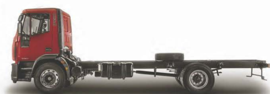
As molas parabólicas da suspensão dianteira têm maior capacidade de absorção de impacto
