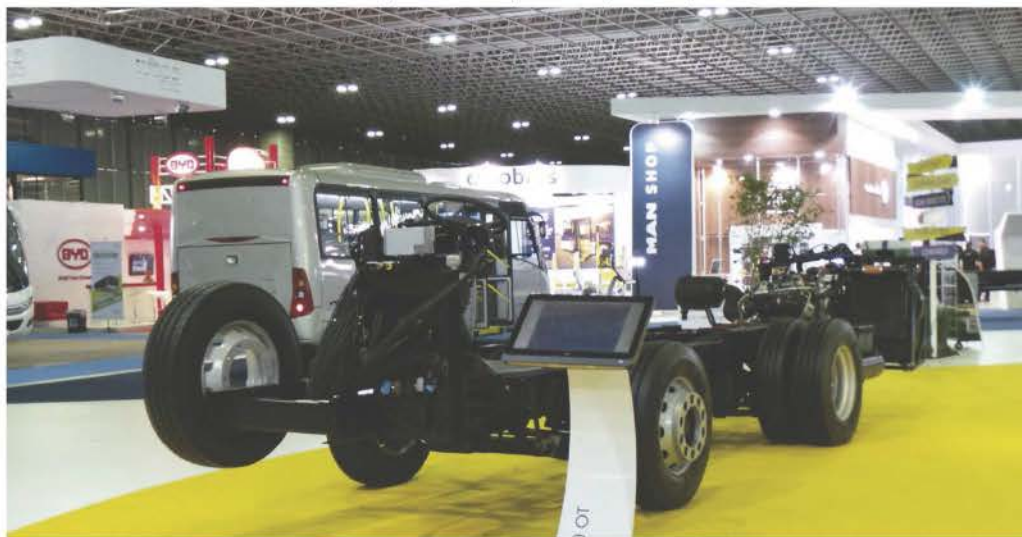
A MAN apresentou o VW 15.230 OT com motor traseiro MAN D08 de quatro cilindros
