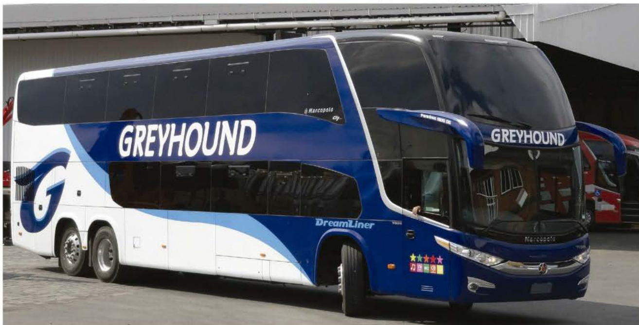
Os ônibus Paradiso 1800 DD encomendados pela Greyhound sul-africana têm direção do lado direito e transporta 60 passageiros
