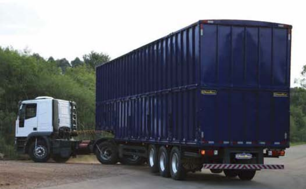
O novo semirreboque carvoeiro tem elevada capacidade volumétrica de carga e piso móvel
