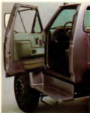
Entrada e saída facilitadas em função da baixa altura do assoalho e estribo adicional.
