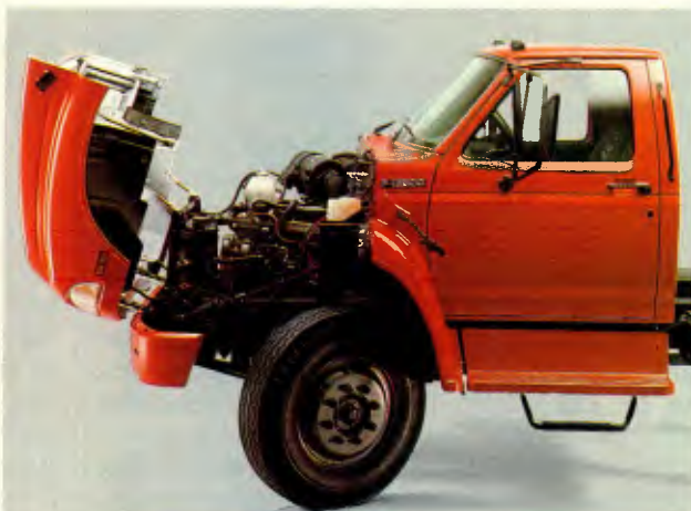
O capuz do motor é basculante, facilitando o acesso aos componentes mecânicos e reduzindo o tempo de manutenção.
