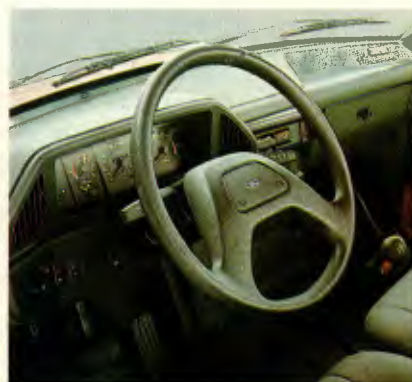
Conjunto de instrumentos integrado. Novo sistema de iluminação para melhor visibilidade. Alarmes luminosos e sonoros para baixa pressão de óleo, alta temperatura, baixo nível de líquido de arrefecimento e baixa pressão do ar do freio.
