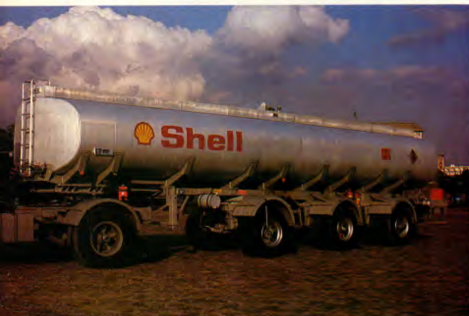
... semi-reboque com tanque de alumínio, ganharam 2,3 t no pbt e mais estabilidade
