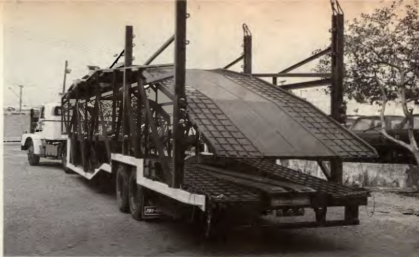
Mecanismo hidráulico eleva e abaixa a plataforma de carga para atender limites de altura
