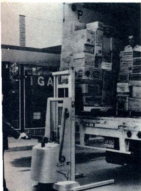
Crown: translação e elevação elétricas.
