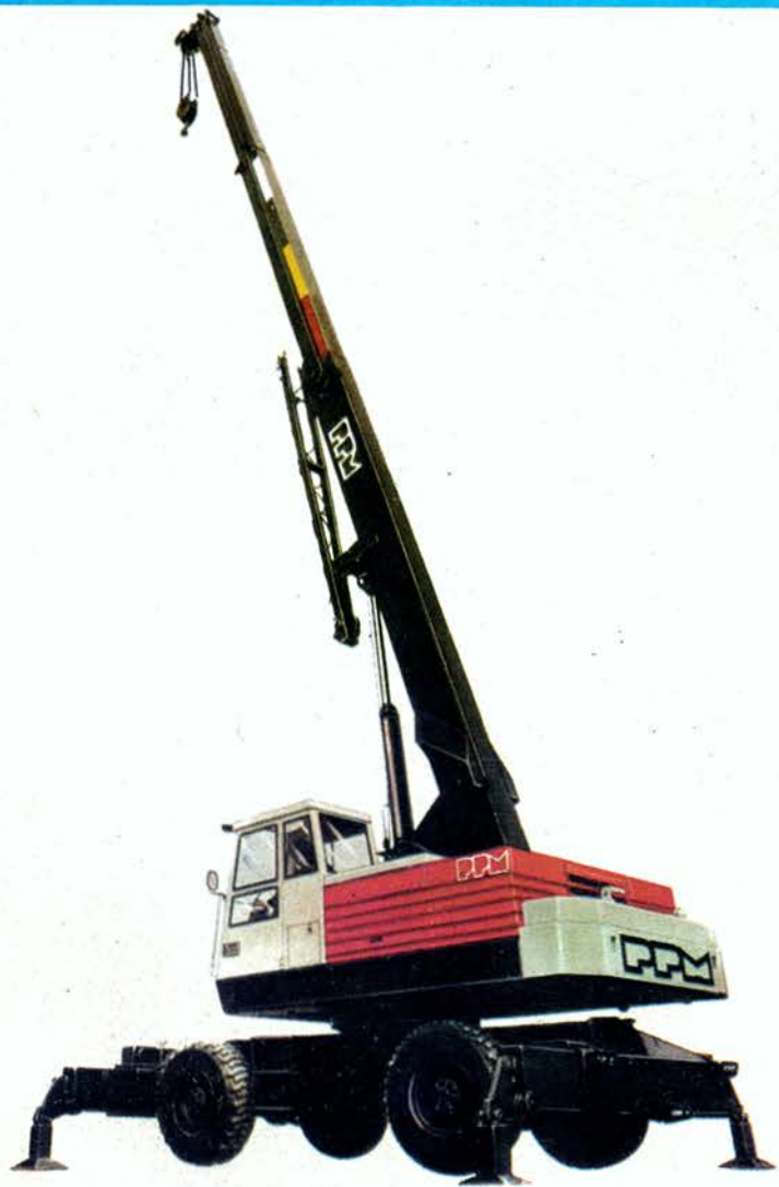
Guindaste hidráulico telescópico PPM. Mod. 18-15 Autopropelido ● Velocidade de estrada: 25 km/h ● Motor de 6 cil. diesel com 87 HP DIN ● Tração nas 4 rodas ● Capacidade: 20 t ● Lança telescópica hidráulica de 3 seções ● Altura máxima: 24 m.
