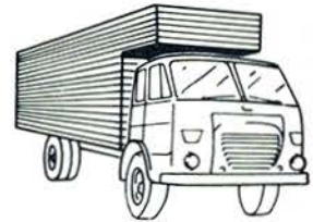
Sobre cabine, a carroceria se projeta sobre a cabine dando maior aproveitamento de espaço.
