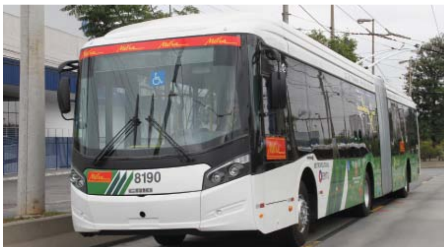
Os trólebus têm chassi Mercedes-Benz O 500 UA de 18 m, com carroceria Caio Millenium BRT
