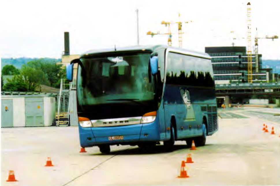
Testes comprovam manutenção de estabilidade do ônibus em manobras bruscas
